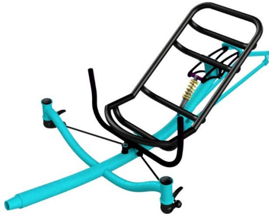
Figura 3.29.- Modelado 3D con consideraciones de componentes principales
