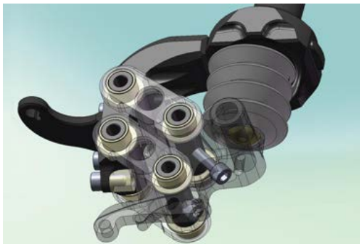
Figura 3.8.- Suspensión en masa delantera (ICE, 2015)
