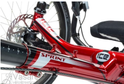
Figura 3.7.- Sujeción tubo de pedalier (ICE, 2015)
