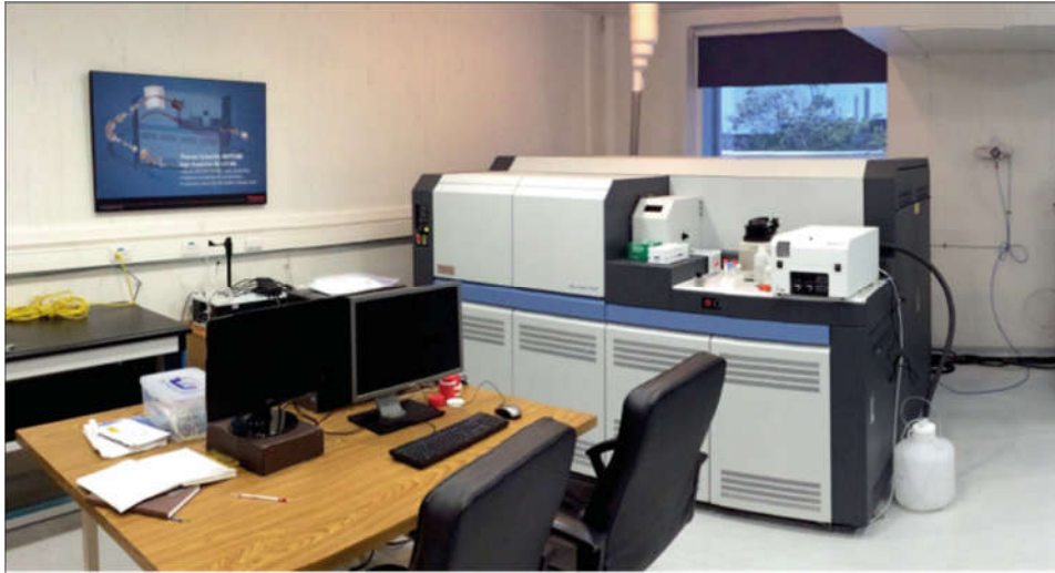
Figura 3-7 Multicolector de alta resolución Thermo Neptune Plus ICP-MS en el laboratorio de estudios isotópicos (LEI)
