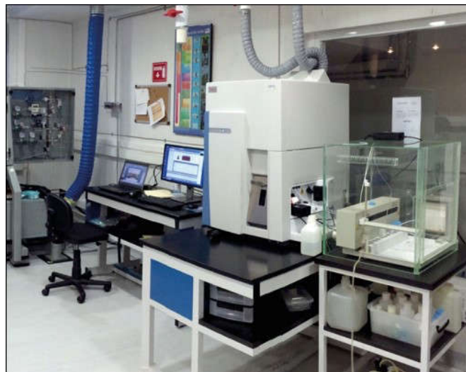
Figura 3-5 Inductively Coupled Plasma Mass Spectrometry (ICP-MS) presente en el laboratorio de estudios isotópico del CGEO.
