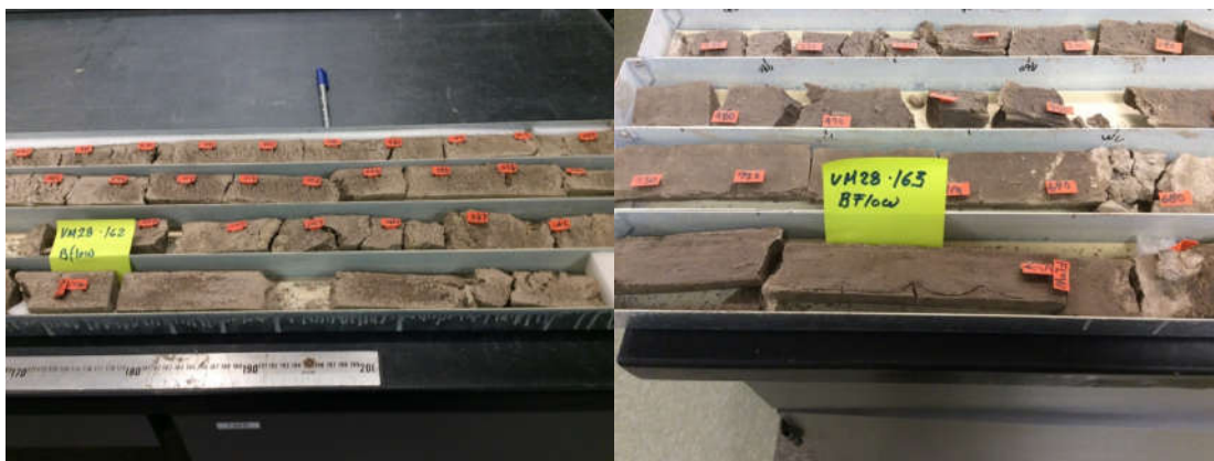
Figura 3-3 Núcleos de sedimentos hemipelágicos recolectados por los cruceros oceánicos del LDEO (muestras reportadas en las figura 3-4).
