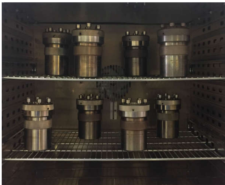
Figura 3-6 - Bombas de alta presión para la digestión en ácidos
