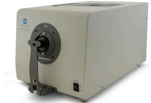
**Figura 5.** Espectrofotómetro Minolta CM-3600d.
