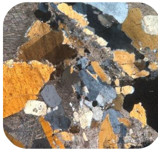
2. Textura en la porción central de la veta. Se observan cristales alargados, aunque también granulares. Puede distinguirse la extinción ondulante del cuarzo 4x NC
