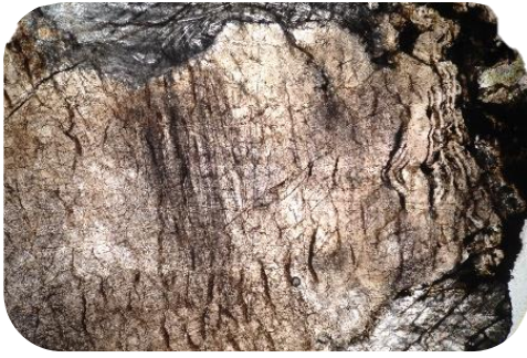
1. BIF discontinuas en un cristal de cuarzo. En el sector central se observan múltiples trazas de inclusiones fluidas. Estas bandas son más próximas entre sí hacia el borde de la veta. 4x LP
