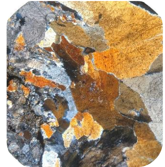
3. cristales con textura de bloques granulares a ligeramente elongados. Se distingue extinción ondulosa y bordes rectos 4x NC
