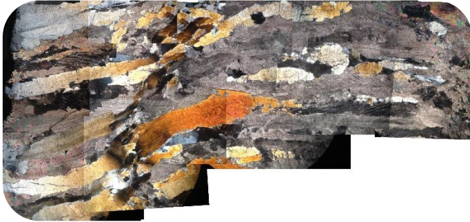
1. Sección transversal de la veta. Cristales fibrosos que cruzan de borde a borde la veta. Se observa una línea media que denota simetría en los cristales. Esta línea se distingue por el cambio en la extinción de los cristales. Los bordes de los cristales son rectos.
