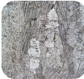
2.Las bandas de inclusiones fluidas se observan orientadas paralelas al borde de la veta y son continuas en varios granos adyacentes. 4x LP
