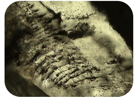
3.BIS y BIF en un cristal de cuarzo. Se distingue que los planos están equiespaciados entre sí y que cada plano contiene ambos tipos de inclusión, sólidas y fluidas. 20x LP
