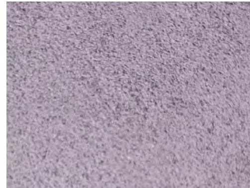
R-11. Concreto Polimerico Mca: Fainteg Color: Gris Tipo: Big Stone Martelinado Áreas: Fachadas
