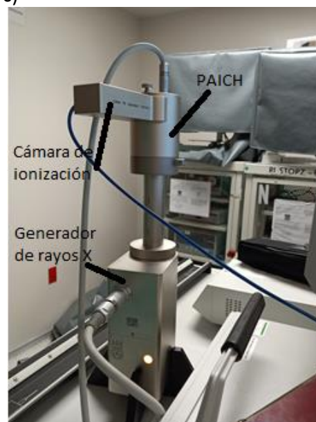
Figura 1.3. a) Ajustador de la sonda, b) Arreglo experimental para evaluar la isotropía del campo de radiación con un arreglo de fotodiodos (PDA), c) montaje del contenedor de la cámara de ionización (PAICH) para evaluación de la tasa de dosis.
