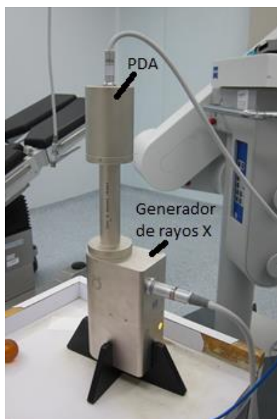
Figura 1.3. a) Ajustador de la sonda, b) Arreglo experimental para evaluar la isotropía del campo de radiación con un arreglo de fotodiodos (PDA), c) montaje del contenedor de la cámara de ionización (PAICH) para evaluación de la tasa de dosis.
