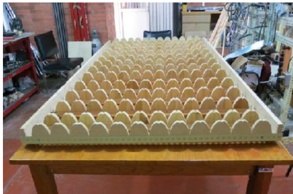
Figura 23. Guías de madera maquinadas en fresadora CNC
