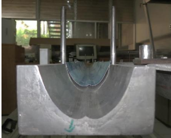
Figura 22. Lámina de aluminio formada en el troquel.
