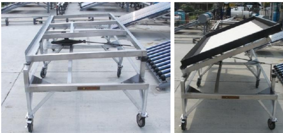
Figura 29. Estructura de soporte con inclinación variable.
