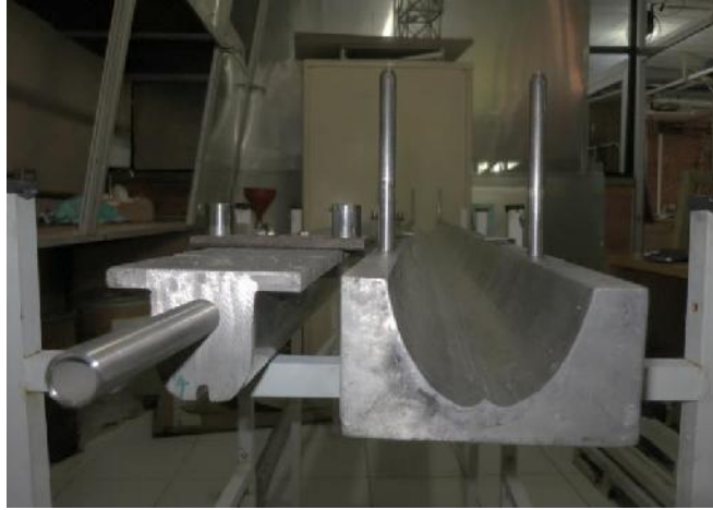
Figura 20. Troquel formador fabricado en aluminio.
