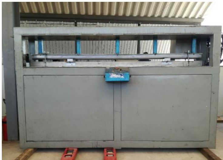
Figura 21. Prensa hidráulica para la formación de parábolas.
