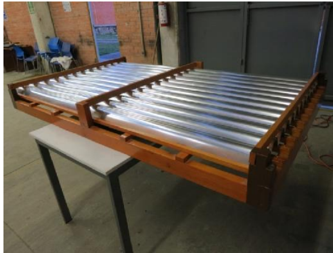
Figura 26. Láminas colocadas en el molde para proceder al espumado.
