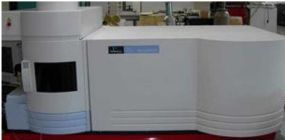
Figura 32. Equipo ICP-OES OPTIMA 4300 DV ubicado en la Facultad de Química, UNAM.
