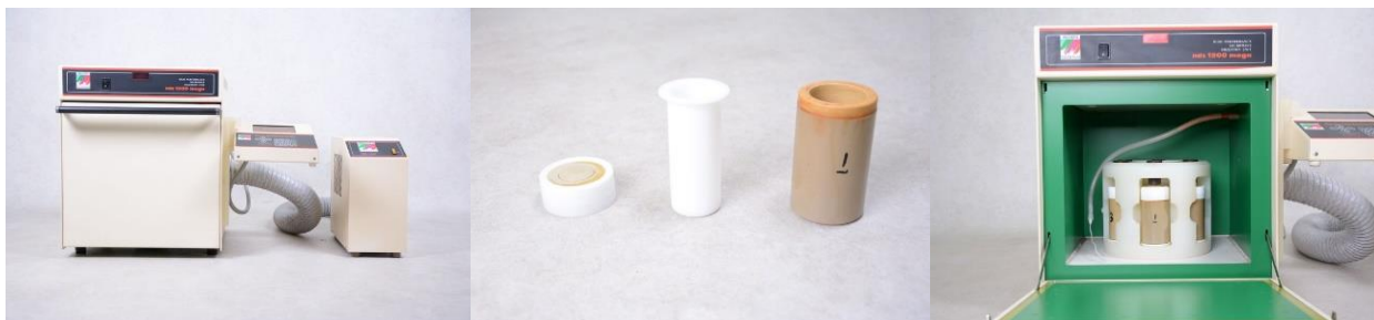
Figura 31. Horno de microondas "High Performance Microwave Digestion Unit 1200" con tubos, tapas y camisas de digestión.
