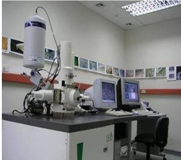
Figura 14: Microscopio electrónico de barrido.(EcuRed)
