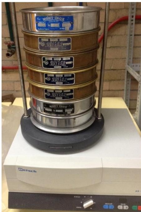
Fig. 8. Tamiz vibratorio Retsch as200.
