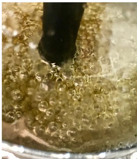
**Figura 4.20. Biogás atrapado por capa superficial de lípidos en biorreactor del equipo AMPTS II**
