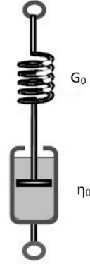
Figura 4.12. Analogía mecánica del modelo de Maxwell (adaptado de Barnes et al., 1989).
