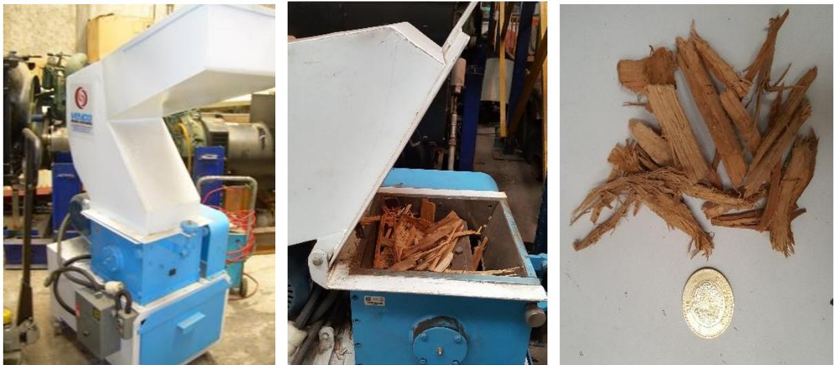
Figura 3.3. Molino de cuchillas y dimensiones finales.
