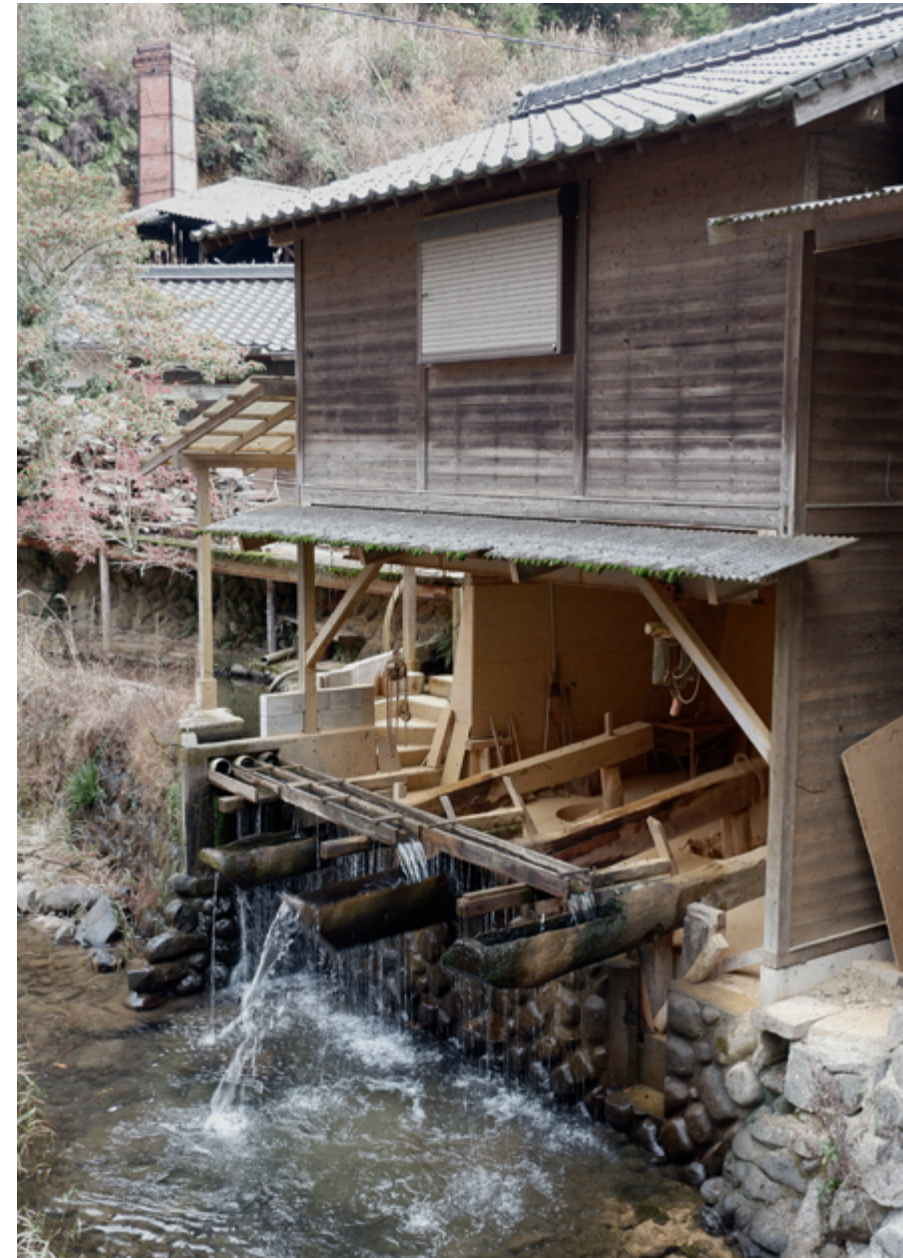
Figura 61 . Karaisu . Molinos de arcilla en Tsurugawachi
