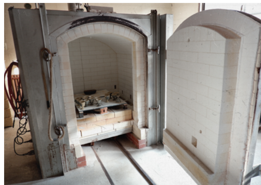
Figura 69 . Horno de gas con ladrillo refractario en el Buzen Kichiemongama
