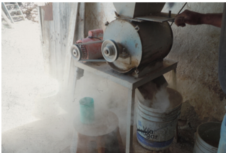
Figura 58 . Molino de arcilla en el taller El Sagrado Corazón
