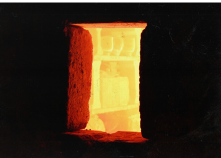
Figura 76 . Quema de esmalte en un Noborigama . Tsurugawachi
