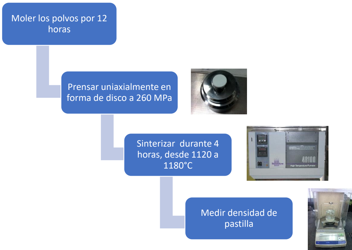
Figura 16.- Esquema del procesamiento de muestras densas de las cerámicas
