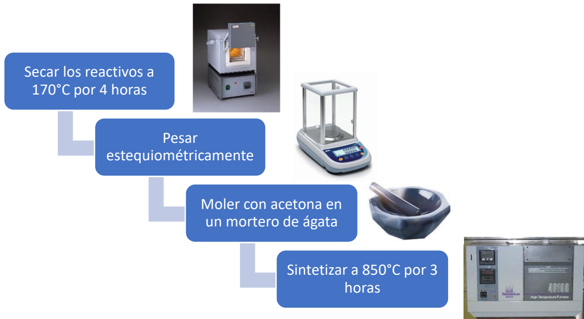
Figura 15.- Esquema del proceso de sinterización de las cerámicas.
