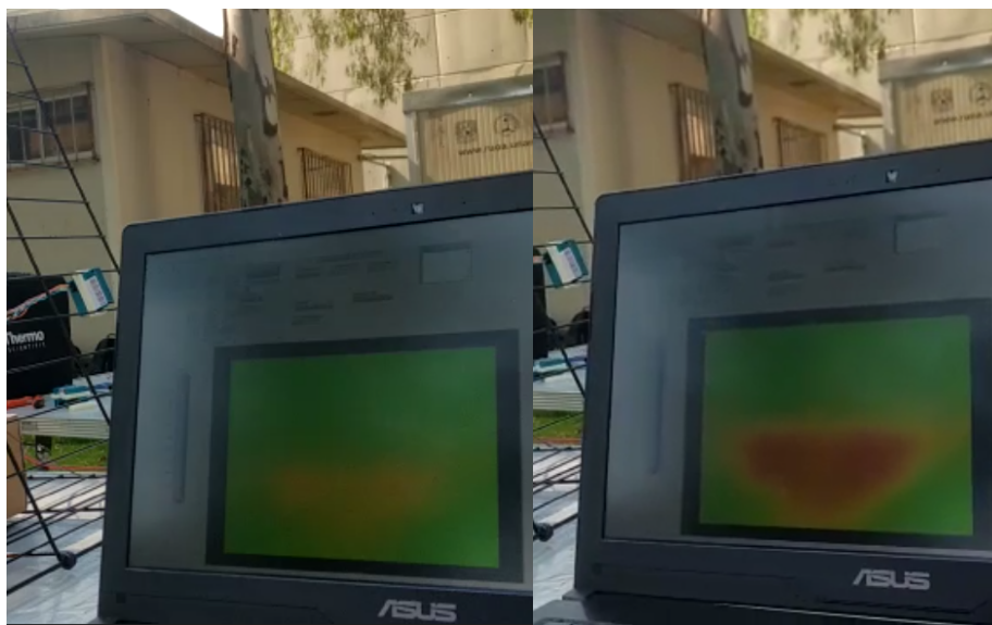
Figura 18. Cambio de concentración de PM2.5 mostrado en la interfaz gráfica desarrollada en LabView. Desarrollado por los estudiantes del CIA, de Maestría Dario Reyes e Israel Gil de Mecatrónica.
