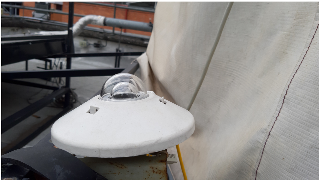
Figura 15: Fotografía del piranómetro Kipp & Zonen CMP6.
