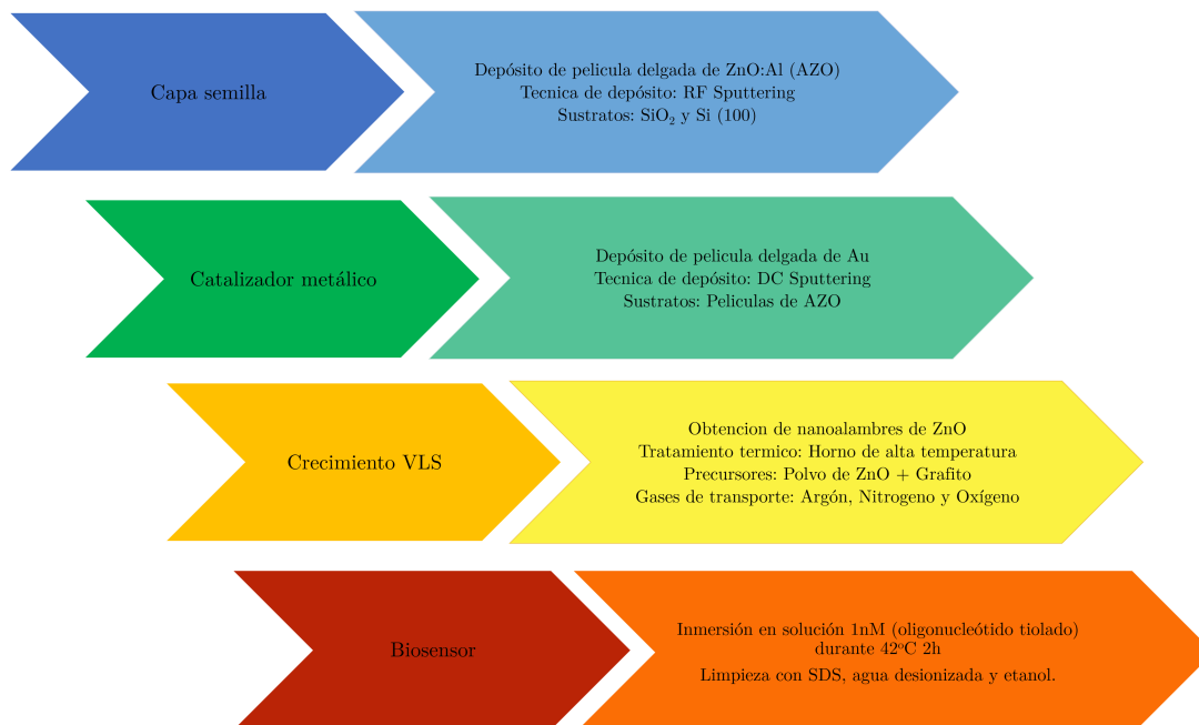
Figura 5.1: Esquema del procedimiento experimental para la obtención de nanoalambres de ZnO.
