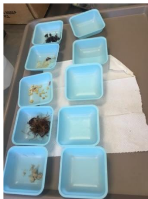
Imagen 3, 4 y 5: Separación de muestras: Muestras de las matrices de maíz, chile, frijol y jitomate separadas en suelo, raíz, tallo, hojas y fruto
