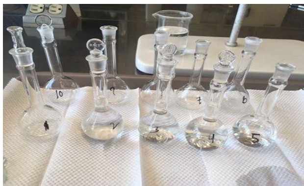
Imagen 11: Disolución stock. En estos matraces se diluyeron distintos volúmenes de disolución madre de mercurio a fin de construir una curva de calibración para el espectro de absorción atómica con vapor frío.
