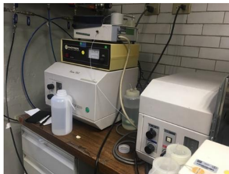
Imagen 14 y 15: Equipo de espectrometría de absorción atómica con vapor frío. Este equipo emplea un generador de hidruros para el análisis de vapor de mercurio.
