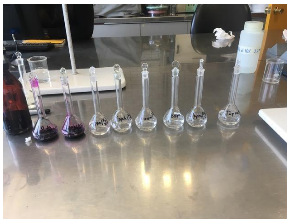
Imagen 12: Remoción del color morado característico de \text{KMnO}_4 . Se deberá de quitar esta coloración para que la técnica de absorción atómica no tenga interferencias.
