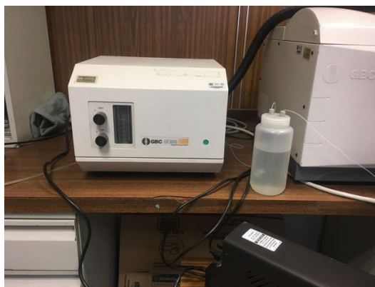
Imagen 16,17 y 18: espectro de absorción atómica con horno de grafito para la determinación de arsénico.
