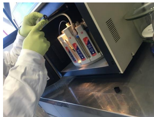
Imagen 7 y 8: Liners montados en los marcos HP-500 y equipados dentro del horno para la digestión ácida
