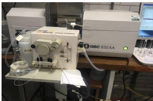
Imagen 14 y 15: Equipo de espectrometría de absorción atómica con vapor frío. Este equipo emplea un generador de hidruros para el análisis de vapor de mercurio.
