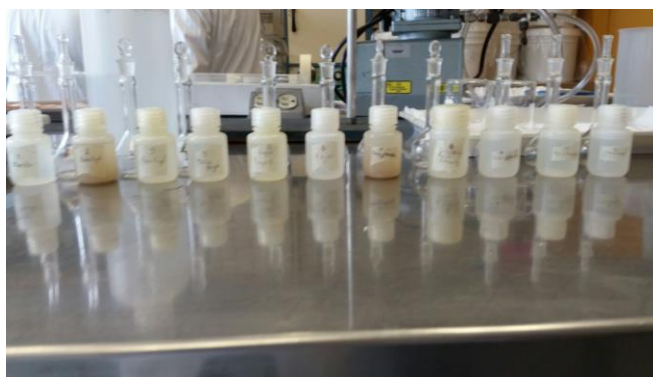
Imagen 9: Frascos de polietileno con el digerido. Este digerido es el que se obtuvo después de que se mezclara el peróxido de hidrogeno con el ácido nítrico y la muestra y posteriormente se realizara la digestión en el horno.
