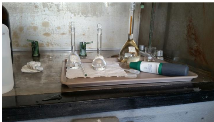
Imagen 10: Preparación de las disoluciones de HCl, borohidruro de sodio y disolución stock. Estas disoluciones se emplearán posteriormente para la generación de vapor frío para el análisis de mercurio.
