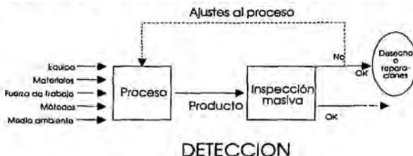
Figura 4.49 Detección de defectos
