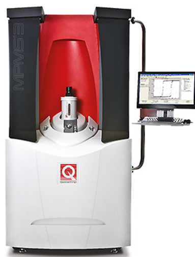
Figura 4.5: Sistema de medición de propiedades magnéticas. Quantum Design modelo MPMS-3.
