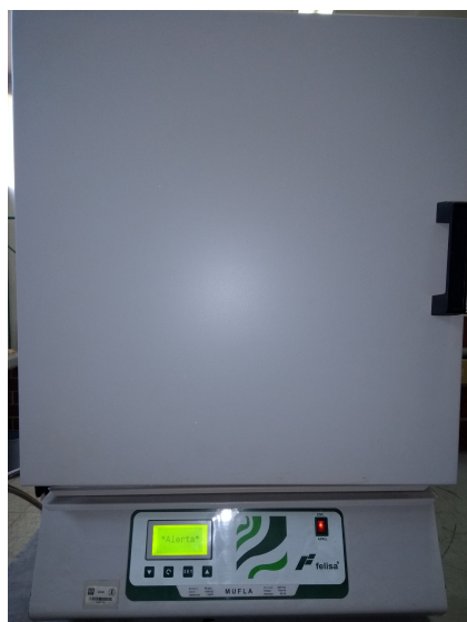
Figura 4.1: Mufla marca FELISA con un intervalo de operación de 50 °C a 1100 °C y resolución de 1 °C.
