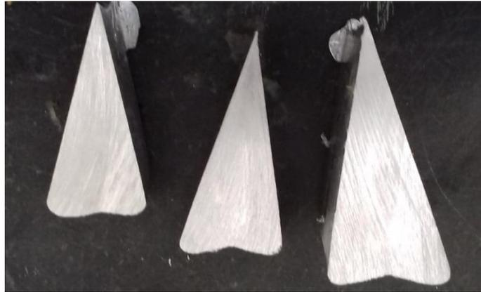
Figura 24. Corte transversal realizado a las piezas para su análisis macro y microestructural.
