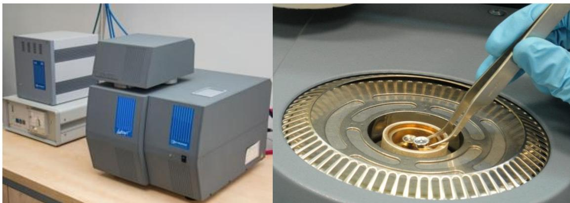
Figura 20. a) Equipo de calorimetría diferencial de barrido, b) Cápsulas o crisoles portamuestras.
