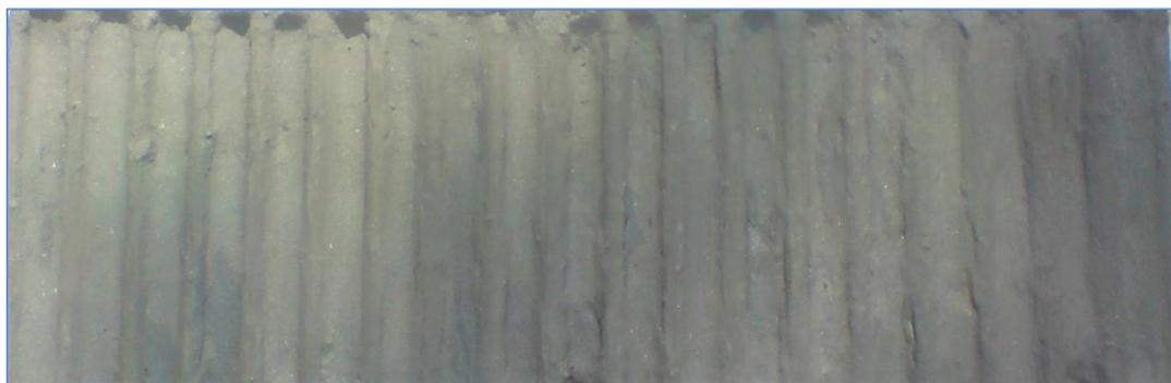
Imagen 4.2. Placa absorbedora hecha por escoria de aceración, limadura de cobre y un adhesivo
