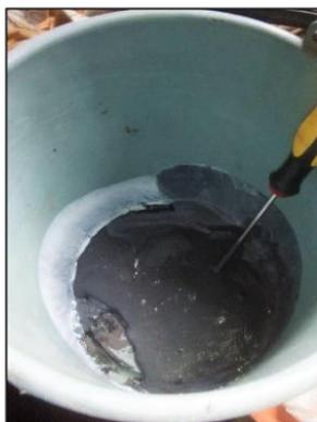
Imagen 3.6. Mezcla de escoria de aceración, adhesivo y limadura de cobre
