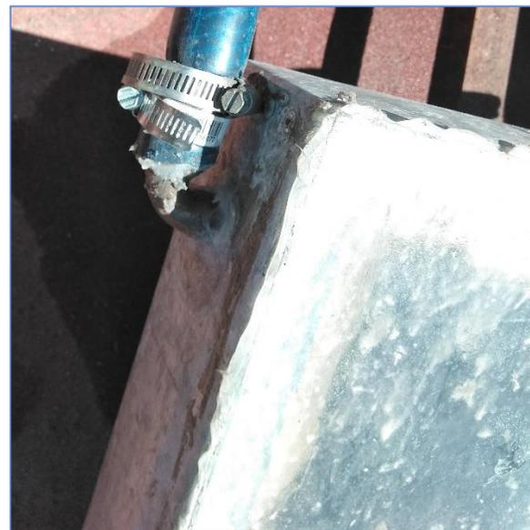
Imagen 4.13. Instalación de una manguera a la carcasa del prototipo
