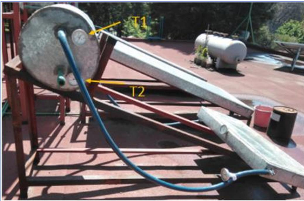
Imagen 4.16. Distribución de los termómetros en el tanque de almacenamiento
