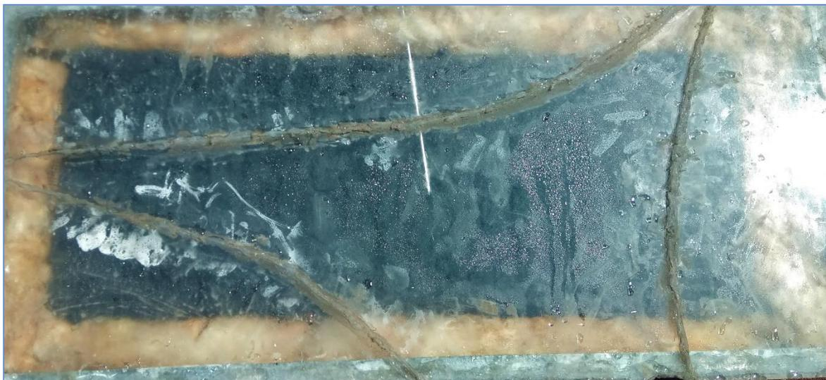
Imagen 4.6. Carcasa recubierta por fibra de vidrio, dentro la placa absorbidora, y cubierta por una capa de vidrio
