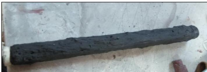
Imagen 3.7. Tubo cubierto por la pintura absorbente radiativa
