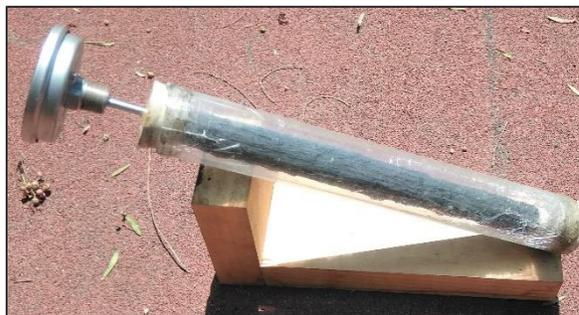
Imagen 3.8. Solarímetro en funcionamiento
