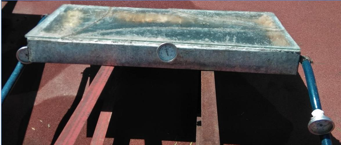
Imagen 4.11. Termómetros instalados en la carcasa del prototipo
