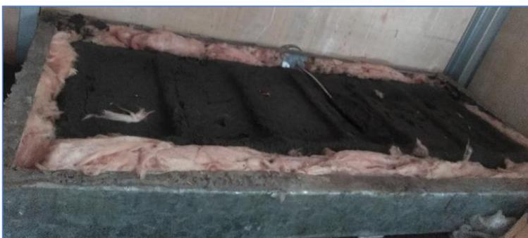
Imagen 4.4. Carcasa recubierta por fibra de vidrio, y dentro la placa absorbidora
