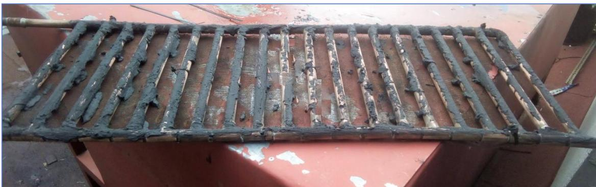
Imagen 4.1. Placa absorbedora de 20 tubos de cobre de  $\frac{1}{2}$  pulgada antes del recubrimiento
