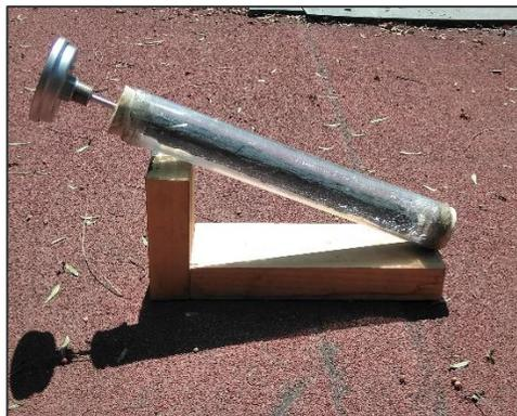
Imagen 3.9. Solarímetro en funcionamiento
