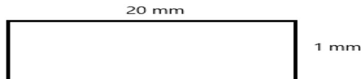
Fig. 5.19. Geometría de la sección transversal propuesta para la viga sometida a flexión..
