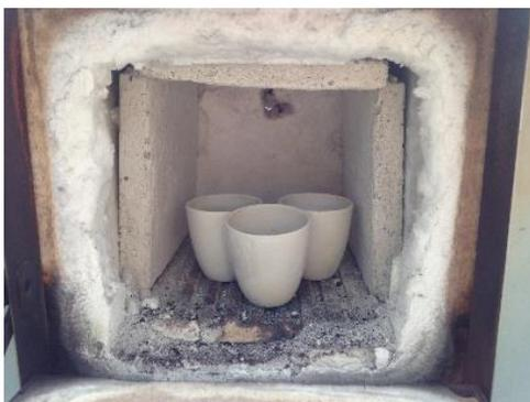
**Figura 13.** Crisoles en la mufla
