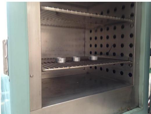
**Figura 7.** Cajas de humedad en estufa
