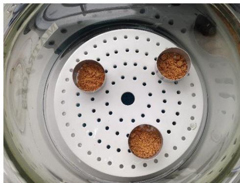
**Figura 8.** Cajas de humedad en desecador
