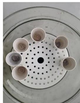
**Figura 14.** Crisoles en el desecador
