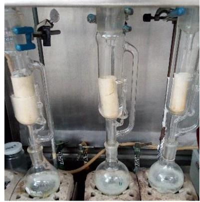
**Figura 9.** Equipo destilación soxlet
