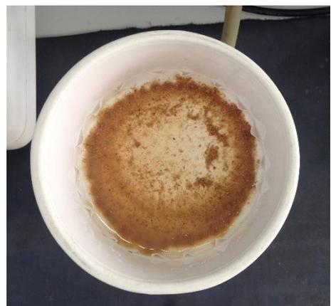
**Figura 12.** Determinación de fibra cruda
