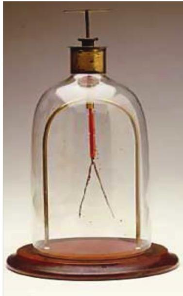
Figura 1.1: Electroscopio, figura tomada de [2]
