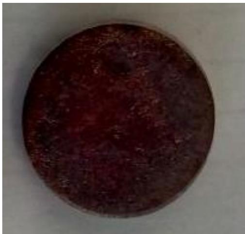
Figura 13. Pastilla de 98.49% Cu-1.40%La<sub>2</sub>O<sub>3</sub>
