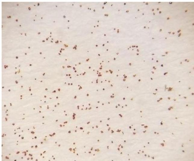
Figura 9. Polvo de cobre malla 325 visto a 20x.
