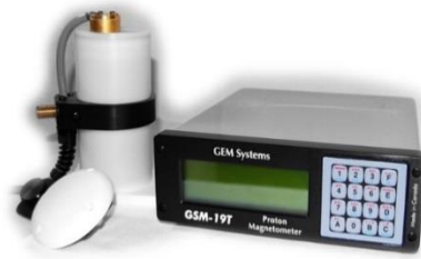
Figura 12. Magnetómetro GSM- 19T Overhouser de Gem System (Tomado de http://www.gemsys.ca/gem-product-catalogue/ ).
