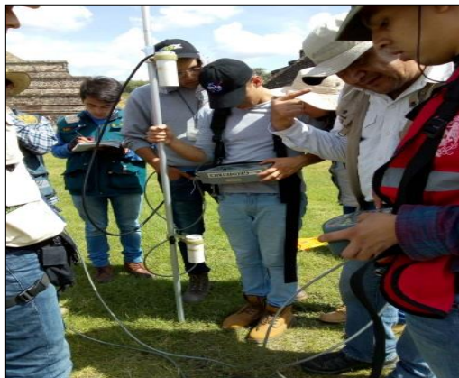
Figura 11. Magnetómetro G-858 MagMapper de Geometrics.
