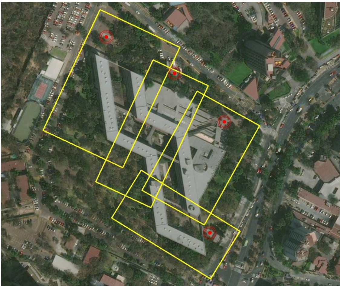
Figura 4.4. Mapa de vuelo de la primera propuesta de plan de vuelos y localización de GCPs. Fuente: Captura de pantalla en QGis.
