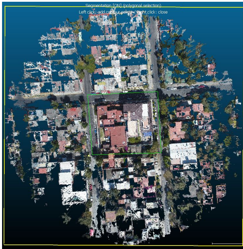
Figuras 3.12a y 3.12b. Uso de la herramienta Segment en CloudCompare sobre una Nube de Puntos Circular. Fuente: Captura de pantalla
