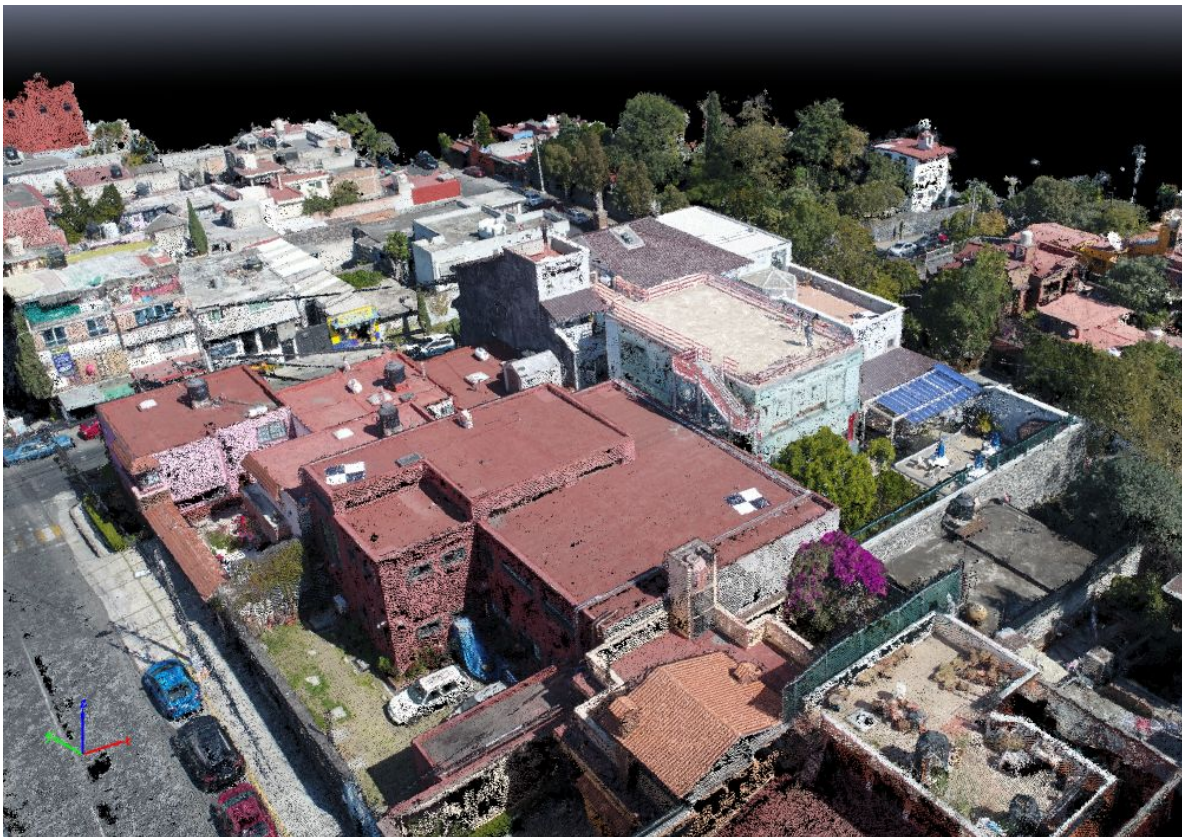
Figura 2.2. Nube de puntos de las instalaciones de Centro Geo. Lomas de Padierna, Tlalpan, CDMX. Obtenida a partir de un vuelo Circular realizado con un VANT DJI Phantom 4 Advanced. Diciembre 2017.
