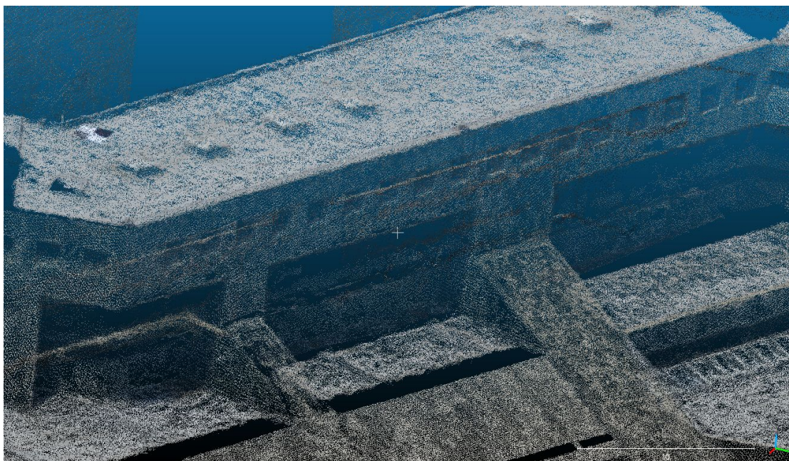
Figura 5.3. Acercamiento a la Nube de Puntos de los edificios de la UPN Unidad Ajusco. Fuente: Captura de pantalla en ClouCompare.
