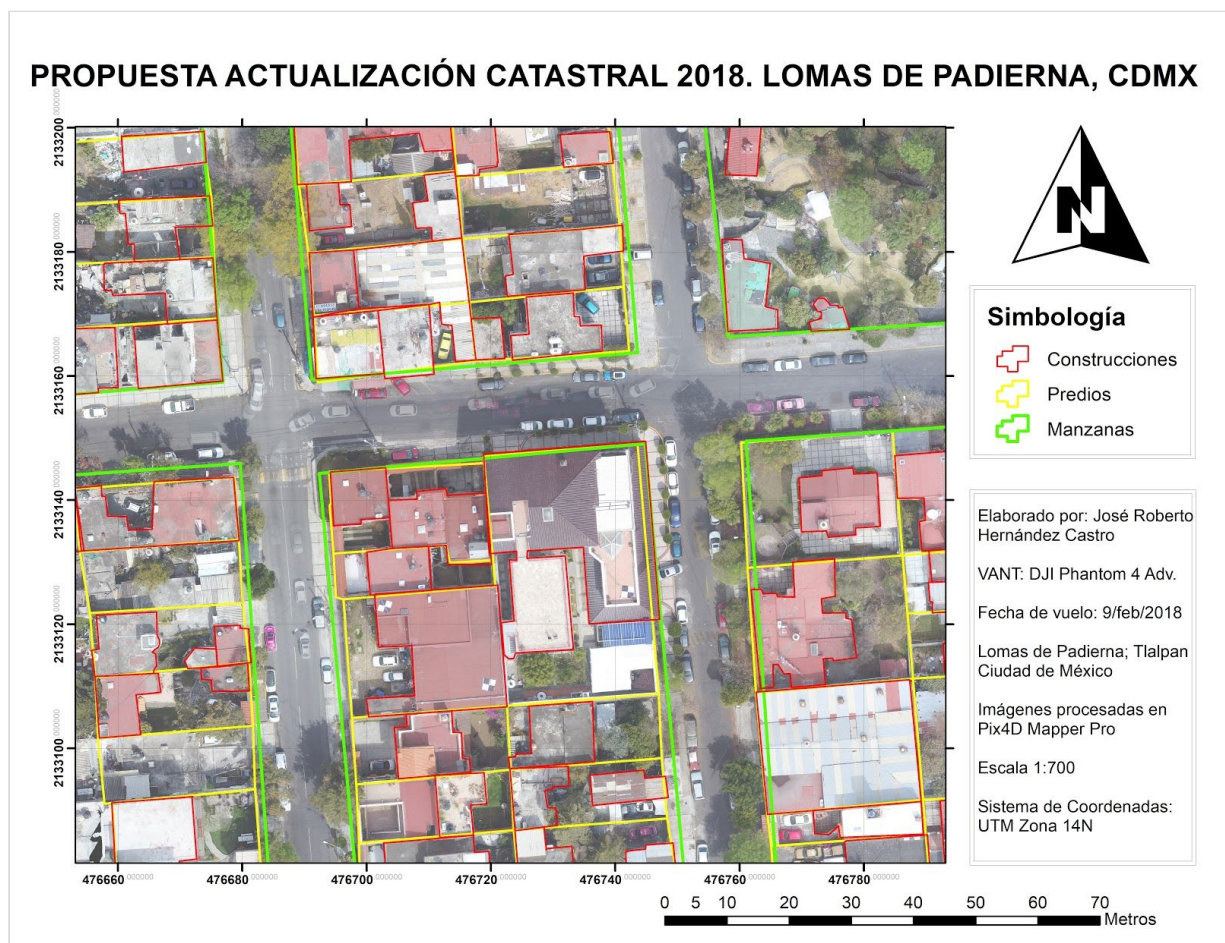
Mapa 2.1. Propuesta de actualización catastral 2018 para una sección de la colonia Lomas de Padierna en Tlalpan, CDMX. Elaboración propia a partir de un vuelo Doble Cuadrícula realizado con un VANT DJI Phantom 4 Advanced. Febrero 2018.
