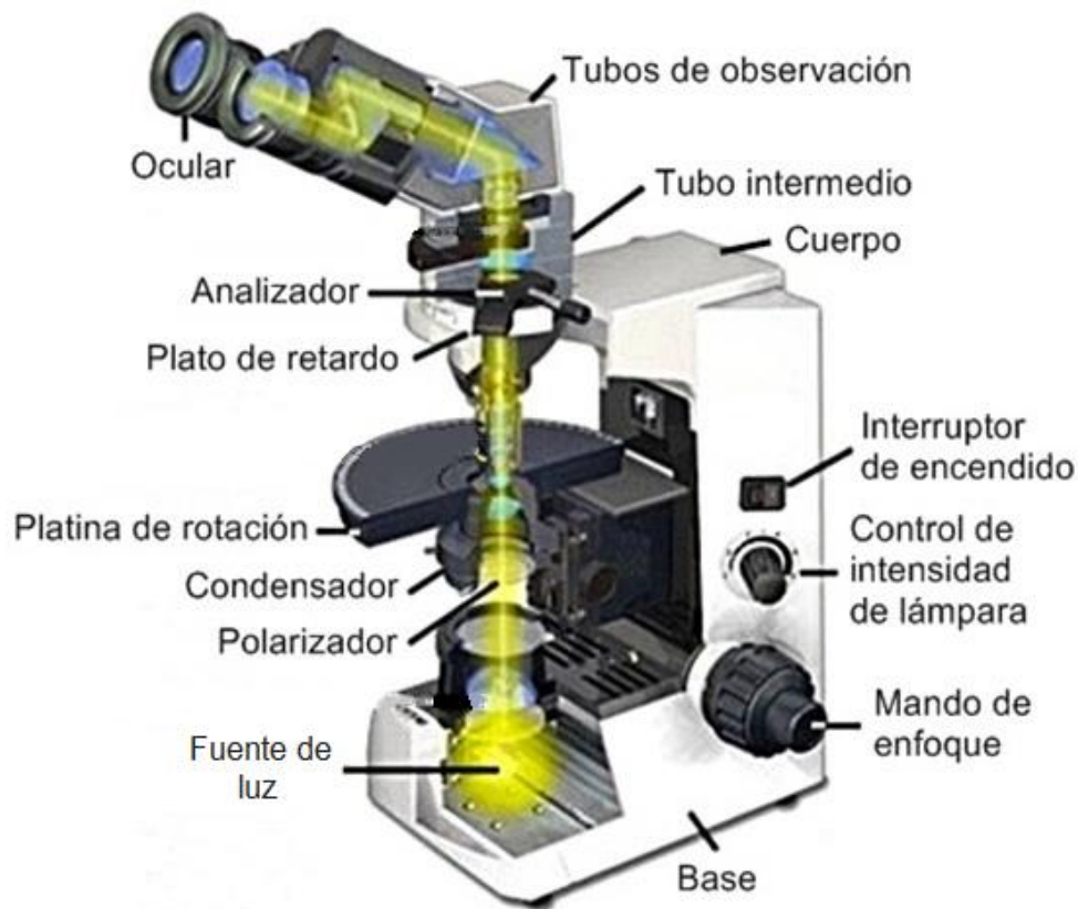
Fig. 7 [18] Configuración básica de un microscopio óptico con luz polarizada.
