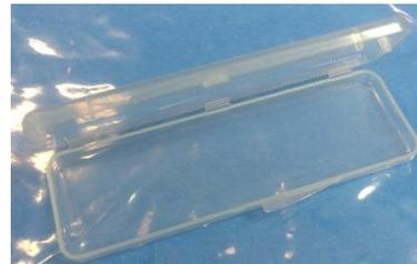
*Ilustración 31: Molde para resistencia a la ruptura.*
