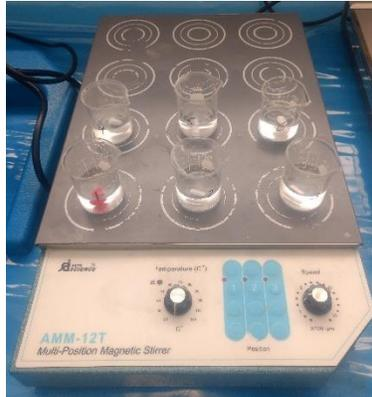
*Ilustración 33: Realización de la prueba de desintegración.*
