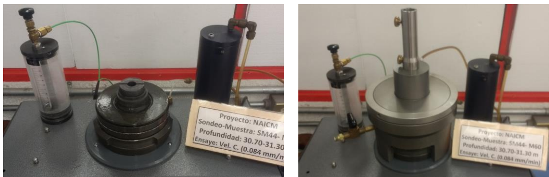
Figura 3.4 Esquema de montaje y fijación del domo
