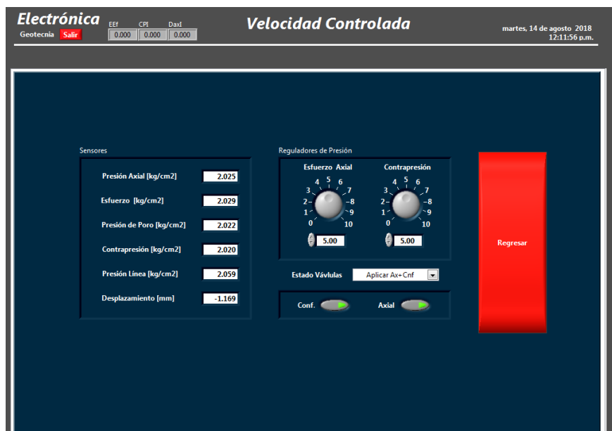
Figura 2.32 Módulo de operación (verificación cruzada)
