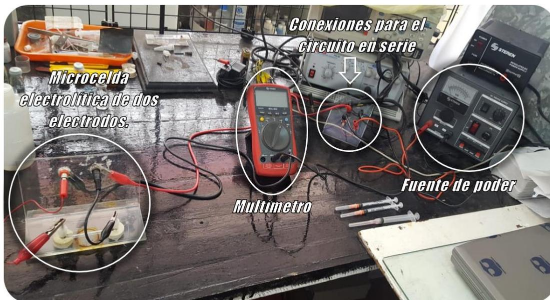
**Figura 6.1** Equipo de mínima instrumentación y bajo costo para realizar las valoraciones microcoulombimétricas yodométricas con detección cronoamperométrica.
