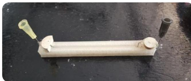
**Figura 3.4** Diseño instrumental de microcelda electroquímica impresa de mínima instrumentación, sin membrana y con electrodos de agujas de jeringa para electrólisis en el régimen de difusión pura por microflujo. La celda es de 8 cm de ancho, 1 cm de altura y 1 cm de profundidad (celda D).
