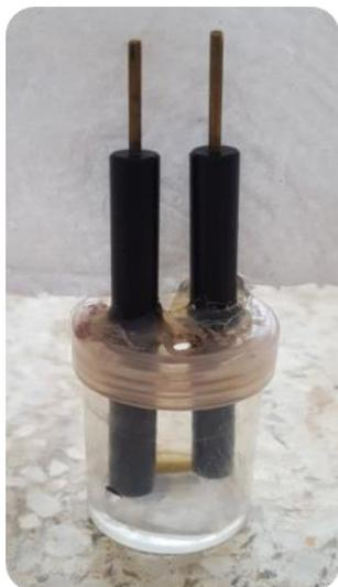
*Figura 3.1* Microcelda electroquímica de mínima instrumentación sin membrana con electrodos de disco de carbón vítreo pulido (celda A).
