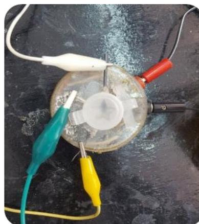
**Figura 4.1** A) microcelda celda empleada con el montaje de los electrodos. B) ídem con el montaje del microagitador – LC.
