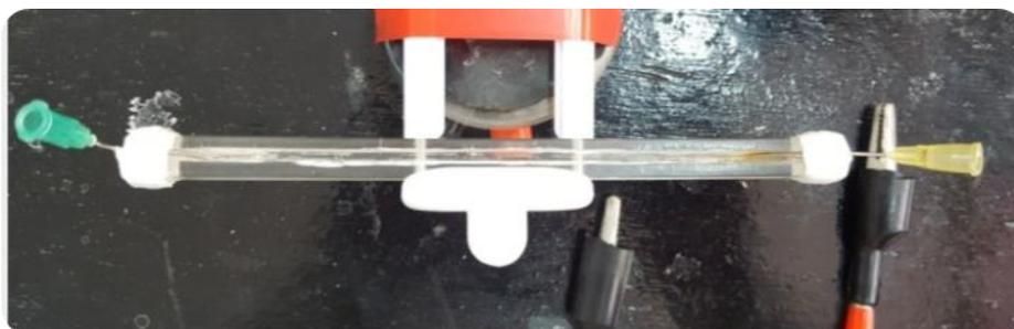
**Figura 3.3** Diseño instrumental de microcelda electroquímica de mínima instrumentación y bajo costo, sin membrana, con electrodos de agujas de jeringa, para electrólisis en el régimen de difusión pura por microflujo. El canal de difusión es de 13 cm de ancho, 0.5 cm de alto y 0.3 cm de profundidad (celda C).
