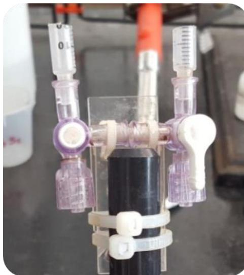
La figura 3.3 muestra la microcelda electroquímica sin membrana del cuarto microcoulombímetro para la realización de la microtitulación coulombimétrica yodométrica con monitoreo visual en el régimen de difusión pura por microflujo.
