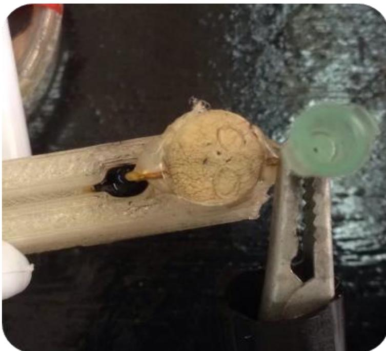
**Figura 3.15** Reservorio para muestras totalmente oscurecido, debido a la reacción de monitoreo visual del fin de la titulación.
