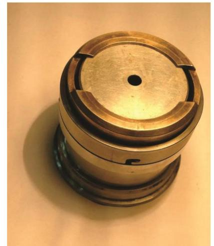
Fig. 2.10 Porta-portamuestras que se utilizó para montar el portamuestras de la Fig. 6b.
