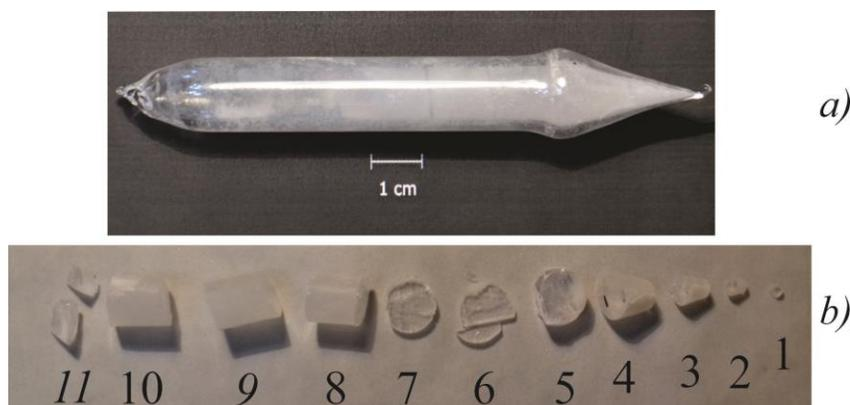
Fig. 2.2 a) Aquí se muestra el bulbo que contiene la mezcla de las sales provenientes de  $\text{KCl}:\text{KBr}:\text{RbCl}:\text{Eu}^{2+}$  (0.5% en masa) y en b) las partes en las que el material se exfolió de manera natural.
