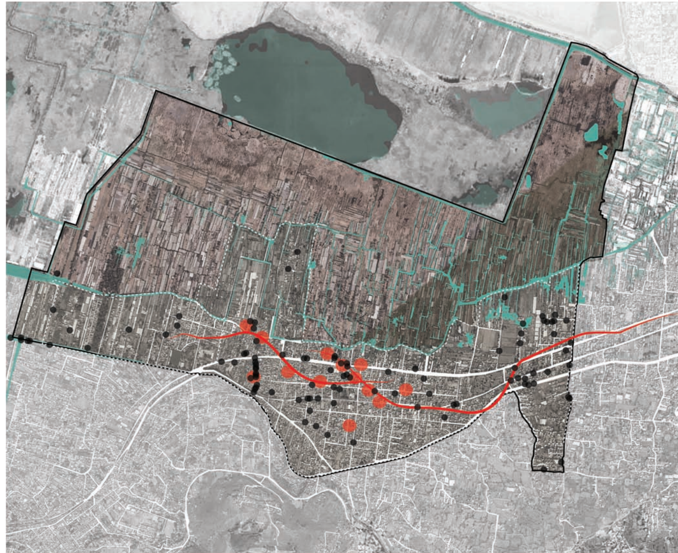
Inmuebles afectados por el sismo+grietas geotécnicas+hundimientos
