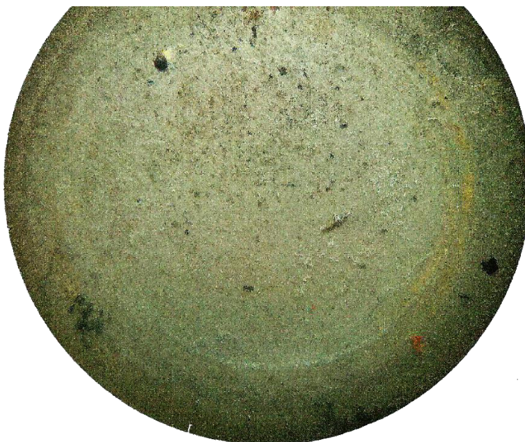
Figura 5. 24. Probeta testigo sellada con cera micro cristalina con cera después de 30 días de inmersión, aumento de 5X en la zona de contacto con el electrolito
