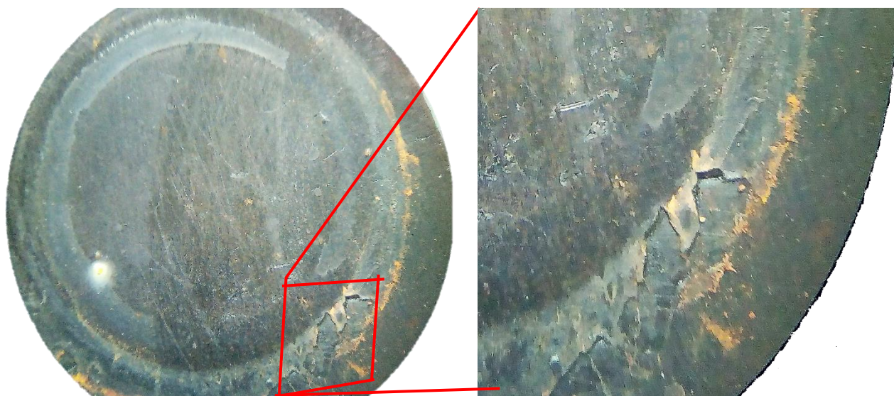
Figura 5. 25. Desprendimiento de cera microcristalina.
