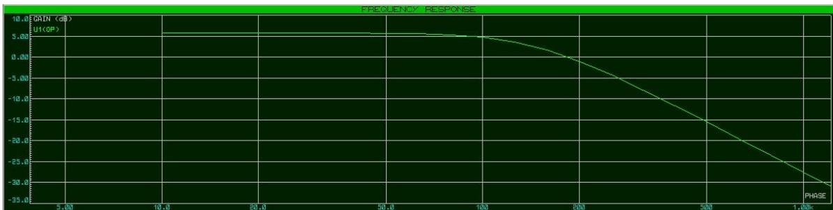
**Gráfica 20** Análisis en frecuencia del circuito integrado con frecuencia de corte en  $150 \text{ Hz}$  Proteus fuente: autor.
