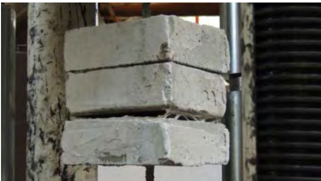
Una vez cumplidos los tiempos de fraguado para cada producto, se realizaron las pruebas de resistencia de los materiales hasta su falla, en este caso a los 650 Kg. Sep-Dic 2012 Crédito: Virginia Arroyo Rodríguez.
