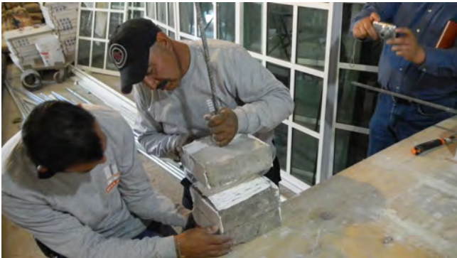
Preparación y aplicación del producto de BASF sobre las muestras preparadas para la realización de las pruebas en el Instituto de Ingeniería. Sep-Dic 2012 Crédito: Virginia Arroyo Rodríguez.
