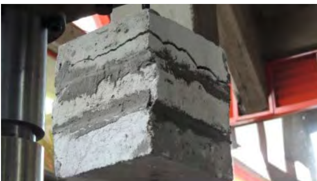
Una vez cumplidos los tiempos de fraguado para cada producto, se realizaron las pruebas de resistencia de los materiales hasta su falla, en este caso a los 1,170 Kg. Sep-Dic 2012 Crédito: Virginia Arroyo Rodríguez.
