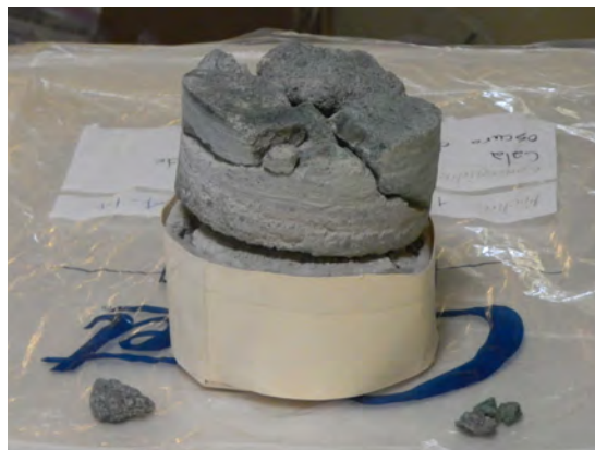
Cala 5. Fachada Poniente/Panel A14. Piedras Verde Oscuro, oquedades en junta fría, colado disgregado, corrosión en armado. Sep.-Dic. 2012. Crédito: Virginia Arroyo Rodríguez.
