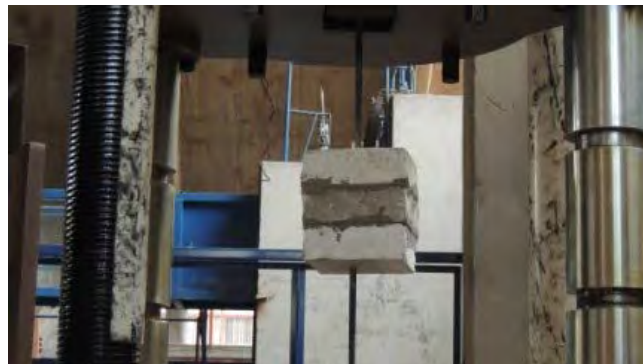
Preparación y aplicación del producto de MAPEI sobre las muestras preparadas para la realización de las pruebas en el Instituto de Ingeniería. Sep-Dic 2012 Crédito: Virginia Arroyo Rodríguez.
