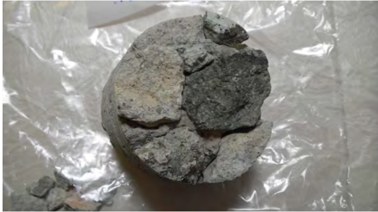
Cala 1. Fachada Norte/Banda de prueba. Piedras Verdes, fractura en el anclaje. Corrosión superficial en el anclaje. Sep.-Dic. 2012. Crédito: Virginia Arroyo Rodríguez.
