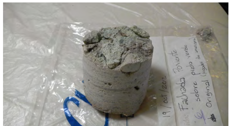
Cala 6. Fachada Poniente/Panel D14. Piedras Verde Claro, oquedades en junta fría, pérdida de material pétreo, presencia de material epóxico. Sep.-Dic. 2012. Crédito: Virginia Arroyo Rodríguez.
