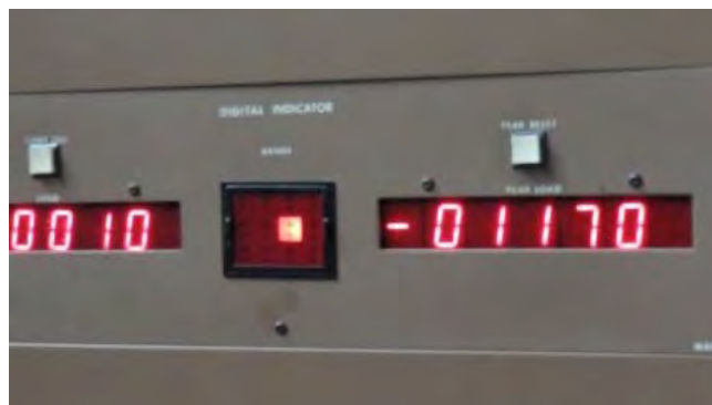
Una vez cumplidos los tiempos de fraguado para cada producto, se realizaron las pruebas de resistencia de los materiales hasta su falla, en este caso a los 1,170 Kg. Sep-Dic 2012 Crédito: Virginia Arroyo Rodríguez.
