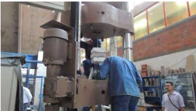
Preparación y aplicación del producto de MAPEI sobre las muestras preparadas para la realización de las pruebas en el Instituto de Ingeniería. Sep-Dic 2012 Crédito: Virginia Arroyo Rodríguez.
