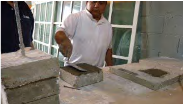
Preparación y aplicación del producto de MAPEI sobre las muestras preparadas para la realización de las pruebas en el Instituto de Ingeniería. Sep-Dic 2012 Crédito: Virginia Arroyo Rodríguez.
