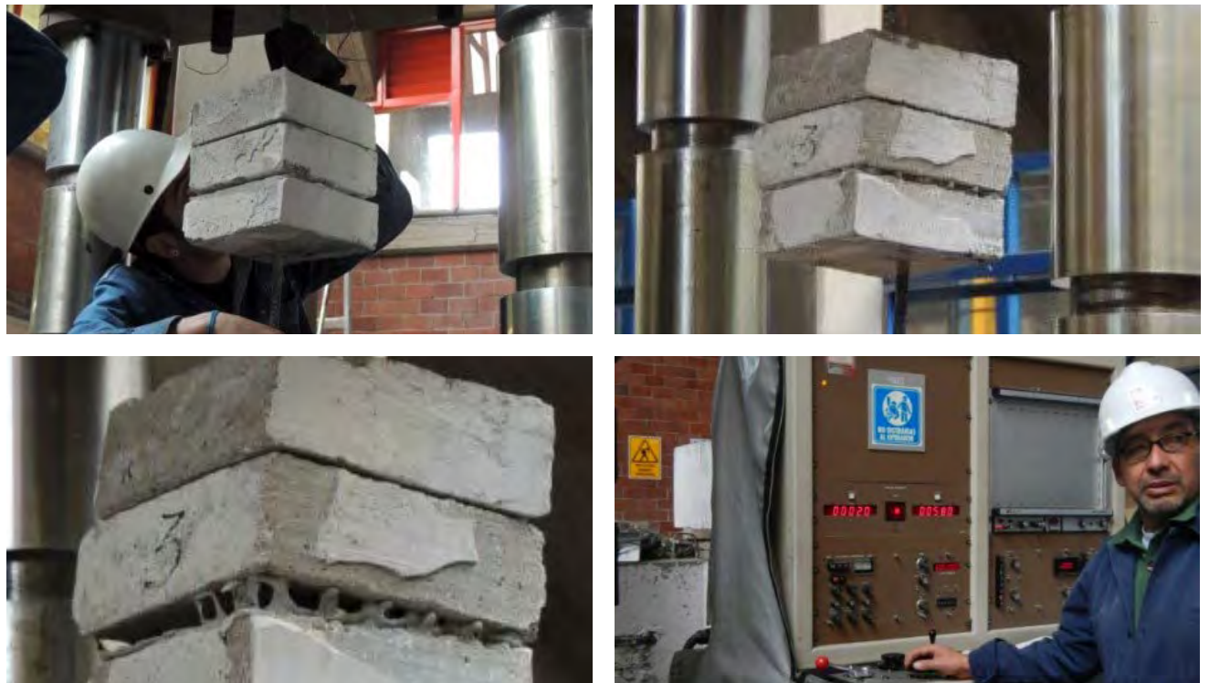
Una vez cumplidos los tiempos de fraguado para cada producto, se realizaron las pruebas de resistencia de los materiales hasta su falla, en este caso a los 580 Kg. Sep-Dic 2012 Crédito: Virginia Arroyo Rodríguez.
