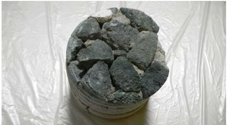
Cala 8. Fachada Sur/Panel Z5. Piedras Gris Violáceo. Disgregación del material de colado, corrosión con migración al concreto, presencia de material epóxico. Sep.-Dic. 2012. Crédito: Virginia Arroyo Rodríguez.
