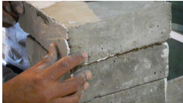
Preparación y aplicación del producto de BASF sobre las muestras preparadas para la realización de las pruebas en el Instituto de Ingeniería. Sep-Dic 2012 Crédito: Virginia Arroyo Rodríguez.
