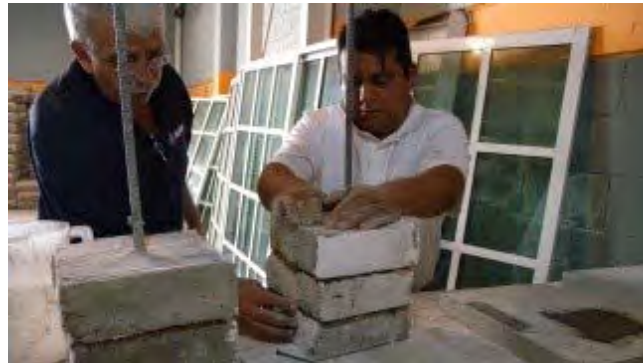
Preparación y aplicación del producto de MAPEI sobre las muestras preparadas para la realización de las pruebas en el Instituto de Ingeniería. Sep-Dic 2012 Crédito: Virginia Arroyo Rodríguez.
