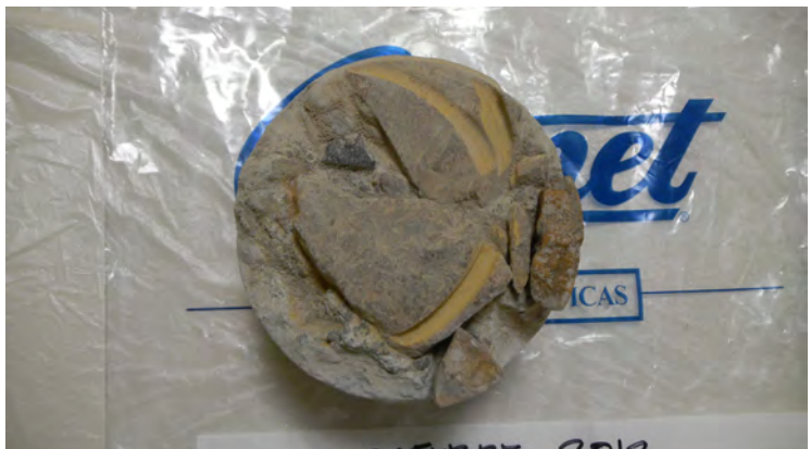
Cala 9. Fachada Sur/Panel S36-37. Vidrio Azul. Fracturas, disgregación del material de colado, eflorescencias salinas, presencia de material epóxico. Sep.-Dic. 2012. Crédito: Virginia Arroyo Rodríguez.
