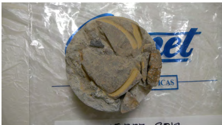
Cala 3. Fachada Norte/Panel Y7. Piedras Amarillo Siena, fracturas y desprendimientos, material epóxico sobre la superficie. Sep.-Dic. 2012. Crédito: Virginia Arroyo Rodríguez.
