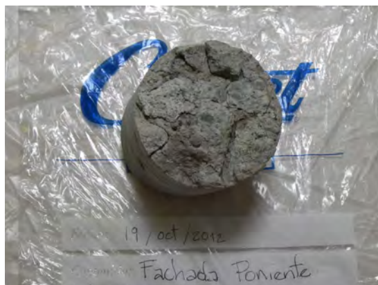
Cala 6. Fachada Poniente/Panel D14. Piedras Verde Claro, oquedades en junta fría, pérdida de material pétreo, presencia de material epóxico. Sep.-Dic. 2012. Crédito: Virginia Arroyo Rodríguez.
