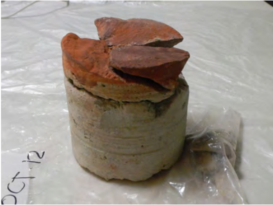
Cala 7. Fachada Sur/Panel A39. Piedras Rojo Venecia, Fracturas en precolado, mala calidad del precolado, presencia de material epóxico. Sep.-Dic. 2012. Crédito: Virginia Arroyo Rodríguez.
