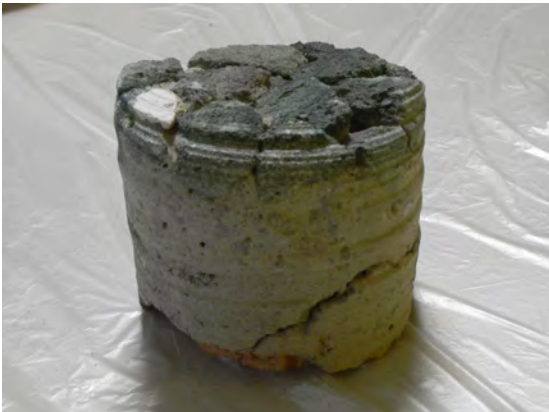
Cala 8. Fachada Sur/Panel Z5. Piedras Gris Violáceo. Disgregación del material de colado, corrosión con migración al concreto, presencia de material epóxico. Sep.-Dic. 2012. Crédito: Virginia Arroyo Rodríguez.
