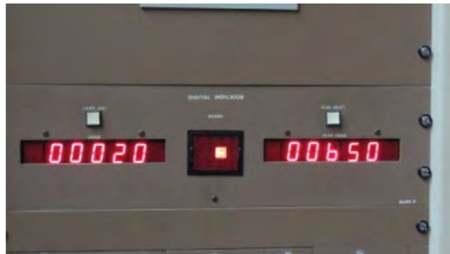
Una vez cumplidos los tiempos de fraguado para cada producto, se realizaron las pruebas de resistencia de los materiales hasta su falla, en este caso a los 650 Kg. Sep-Dic 2012 Crédito: Virginia Arroyo Rodríguez.
