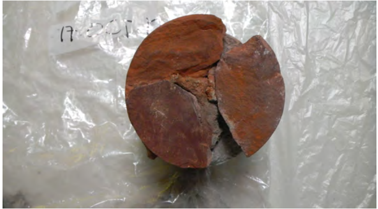
Cala 7. Fachada Sur/Panel A39. Piedras Rojo Venecia, Fracturas en precolado, mala calidad del precolado, presencia de material epóxico. Sep.-Dic. 2012. Crédito: Virginia Arroyo Rodríguez.
