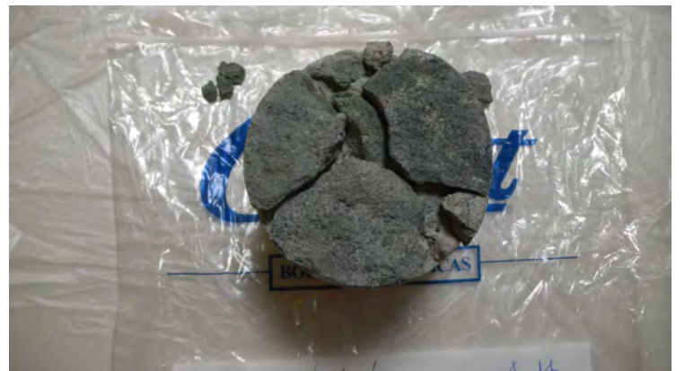
Cala 5. Fachada Poniente/Panel A14. Piedras Verde Oscuro, oquedades en junta fría, colado disgregado, corrosión en armado. Sep.-Dic. 2012. Crédito: Virginia Arroyo Rodríguez.
