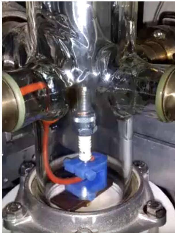
Figura 5.15: Fotografía de la bujía empleada para la generación de NO_2 , NO_3 y O_3 .
