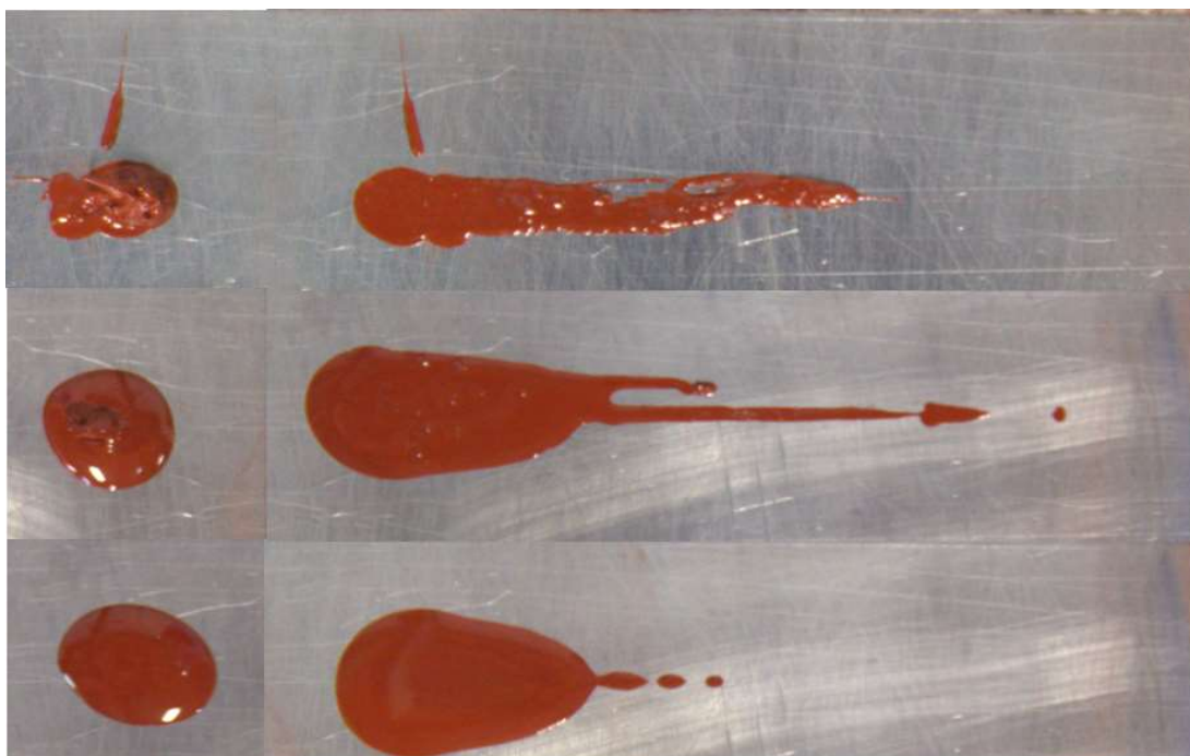
Figura 4.18: Trazos experimentales para la mezcla Rojo a una velocidad de 15 m/s, altura de espátula de 0.5 mm para: a) 50 °C, b) 60 °C, c) 80 °C.
