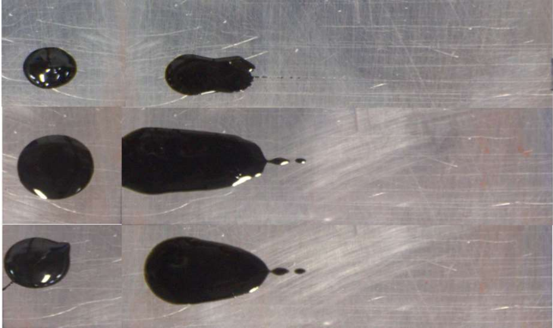
Figura 4.17: Trazos experimentales para la mezcla Negro a una velocidad de 15 m/s, altura de espátula de 0.5 mm para: a) 50 °C, b) 60 °C, c) 80 °C.
