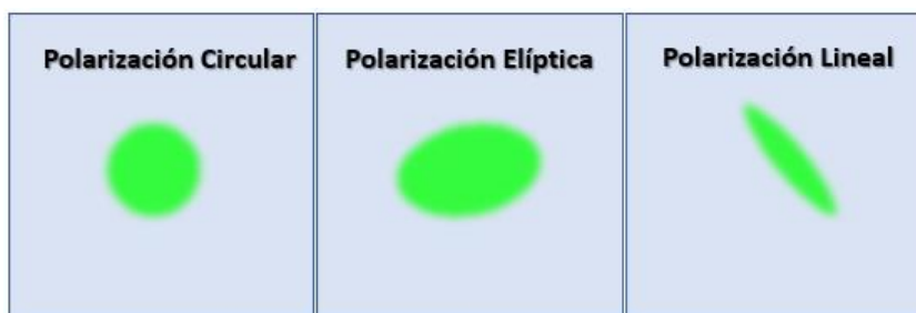
Fig. 3.7: Silueta de la distribución de energía del haz de luz láser según el estado de polarización.
