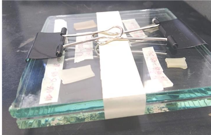
Figura 20. Tratamiento de las muestras para ángulo de contacto
