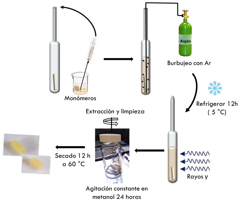
Figura 19. Proceso experimental para la síntesis de (PVC-g-NIPAAm)-g-4VP y PVC-g-4VP por el método de directo.
