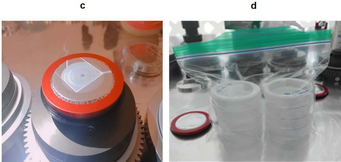
Figura 2.9. (a) MOUDI (b) Partes del MOUDI (c) filtro con muestra (d) filtros almacenados.
