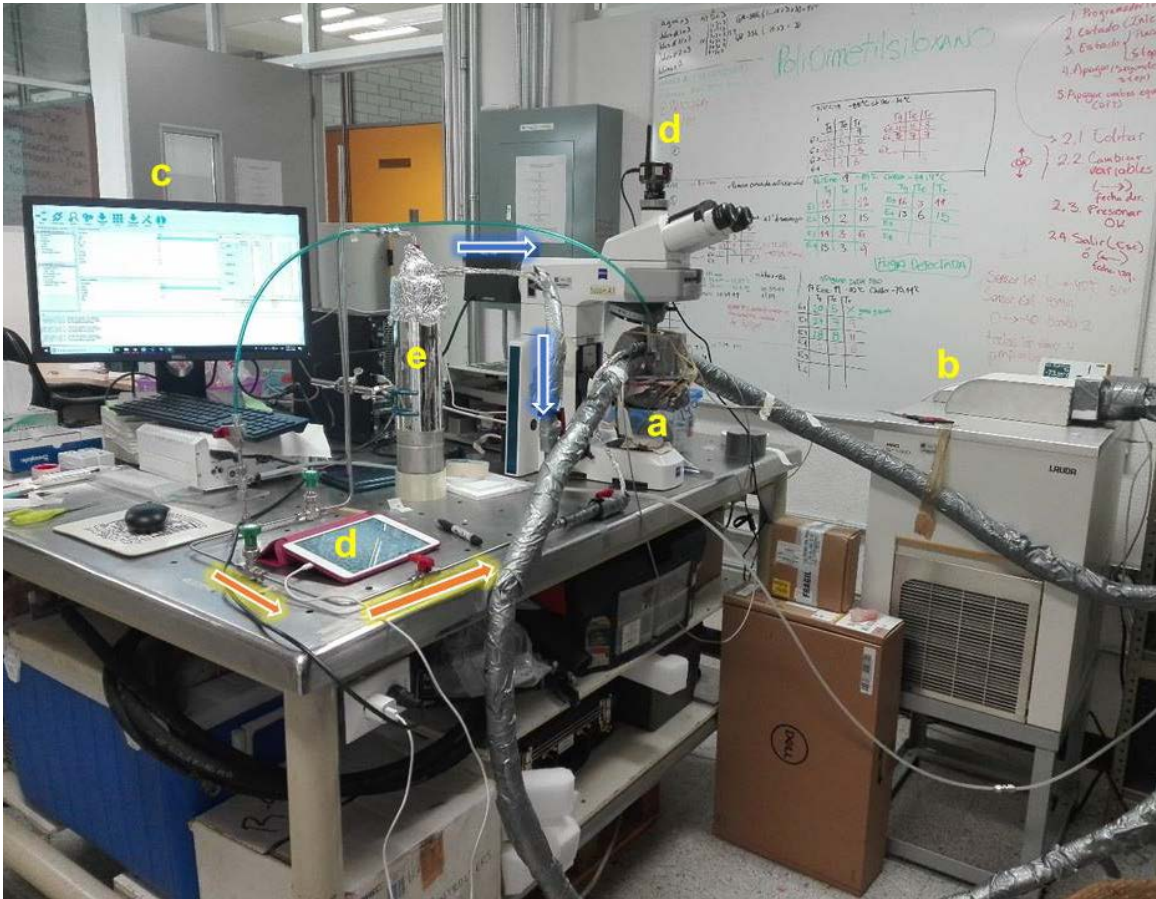
Figura 2.11. Droplet Freezing Technique (DFT). (a) área de estudio, (b) sistema de enfriamiento, (c) sistema de adquisición de datos, (d) sistema de video, (e) sistema de alimentación de aire húmedo y seco.
