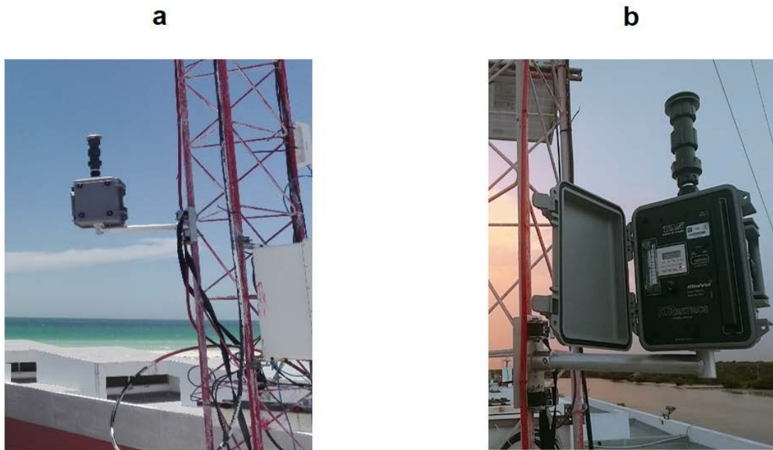
Figura 2.6. (a) Montaje del minivol para la toma de muestras verano-2018. (b) Parte trasera y parte frontal del minivol.
