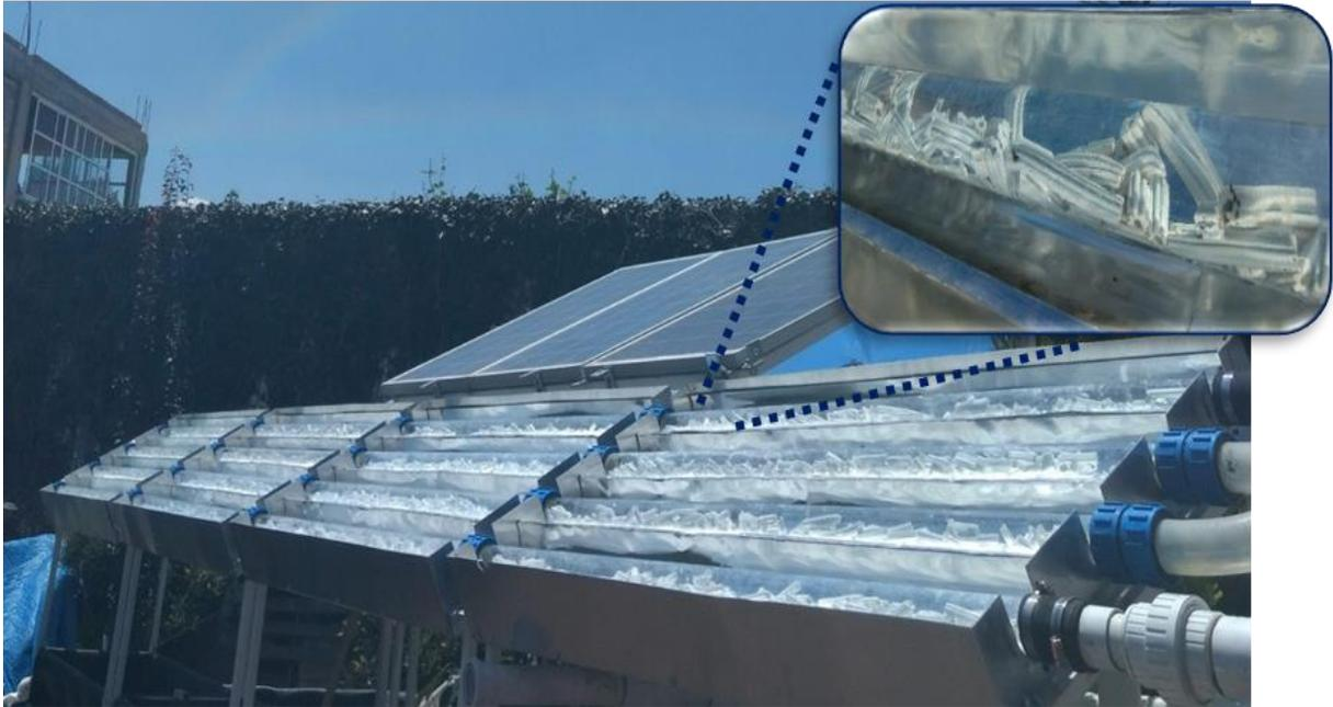
Figura 5-8 Configuración “E” y “Ex”. Piezas de TiO<sub>2</sub> extruidas y empacadas.
