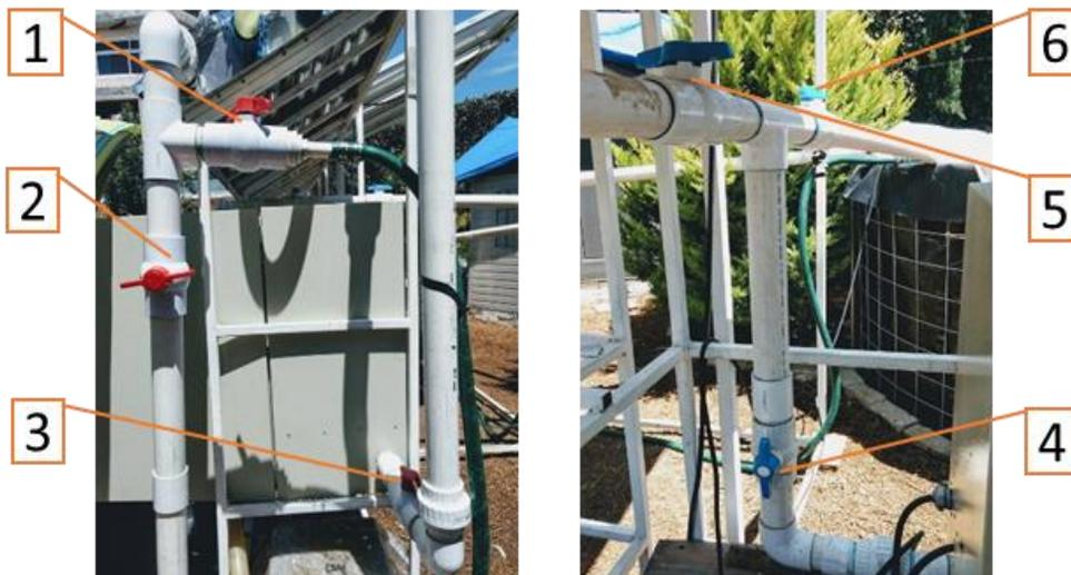
Figura 13-3 Válvulas del reactor fotocatalítico
