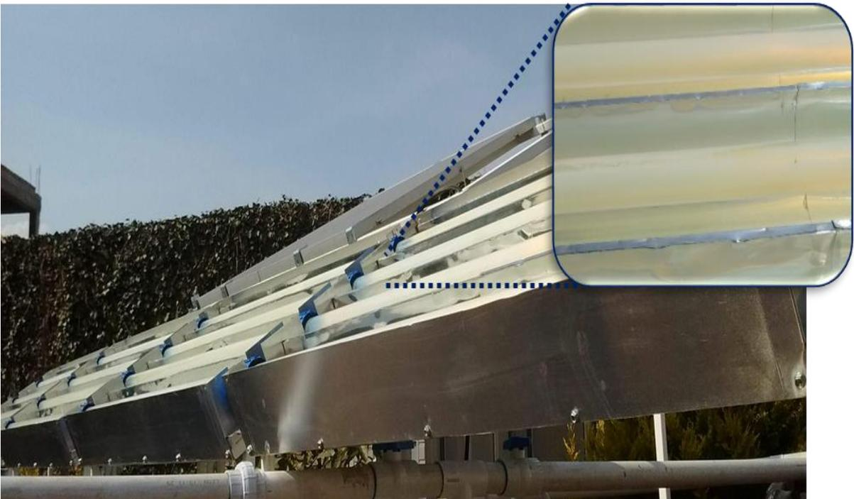
Figura 5-7 Configuración "F" Película de  $\text{TiO}_2$
