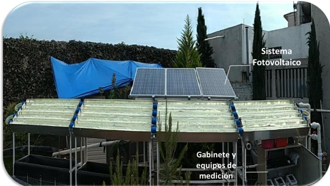
Figura 5-4 Reactor fotocatalítico CPC, sistema fotovoltaico y gabinete.
