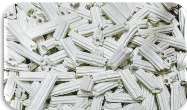
Figura 5-10 Piezas extruidas en forma estrella-cilíndricas.
