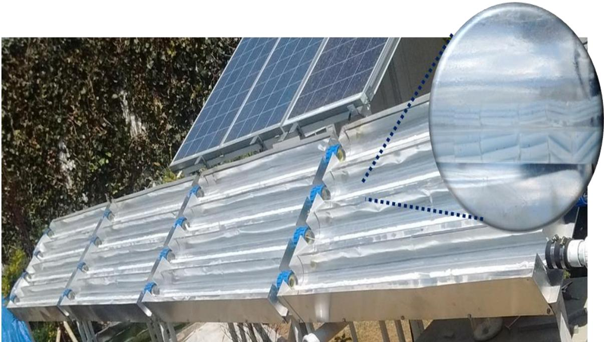
Figura 5-6 Configuración "L". Piezas extruidas de  $\text{TiO}_2$  en línea.
