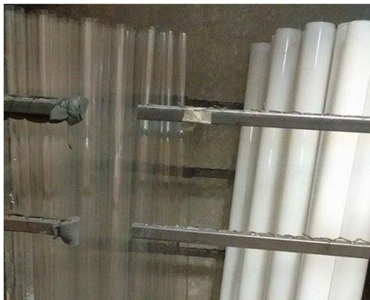
Figura 5-9 Tubos impregnados de  $TiO_2$ , dentro del horno para su post-calentamiento. Forma inmovilizada “Película”
