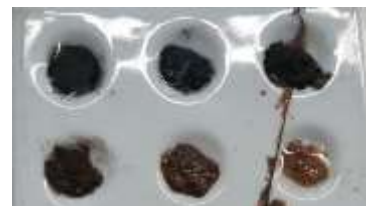
Figura 2. Reacción de suelo al agregar HCl al 10 %
