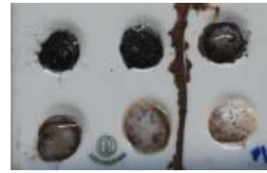
Figura 3. Reacción de suelo al agregar H_2O_2 al 30 %.
