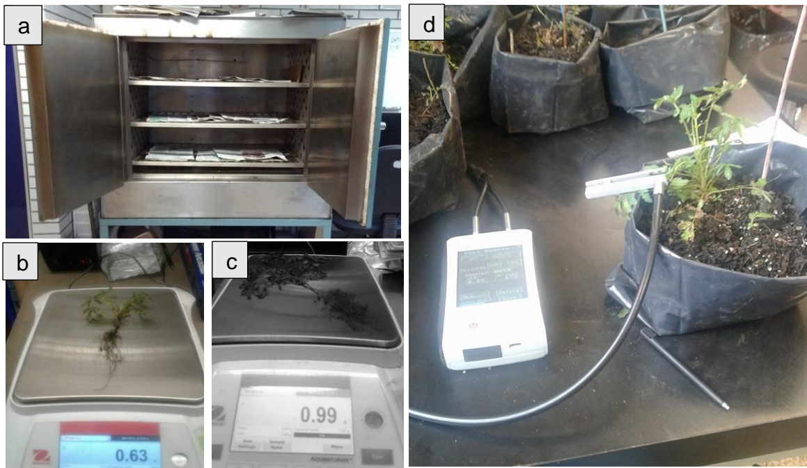
Figura 12. Obtención de algunas variables de las plantas de A. elongata : a) Secado del material vegetal en una estufa, b) y c) peso fresco y seco del material vegetal, respectivamente en una balanza analítica y d) medición de clorofila en la plántula.
