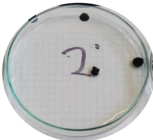
**Figura 27. Gota de pintura acrílica, estando en contacto con la disolución 70/30.**
