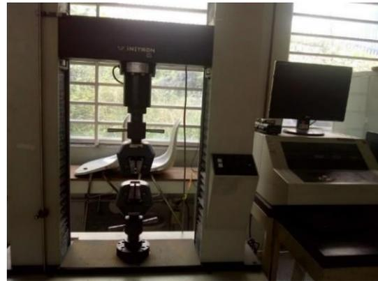
*Figura 3.11: Equipo para ensayo de tensión, INSTRON.*
