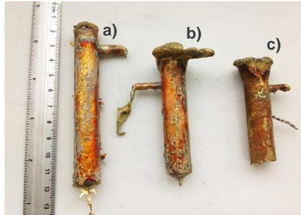
Figura 3.3: Probetas obtenidas de fundición y solidificación en a) molde de cobre, b) acero y c) molde de arena
