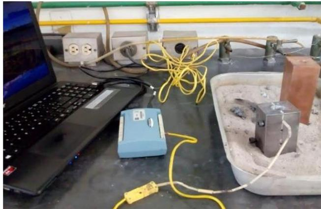
*Figura 3.5: Equipo utilizado para la adquisición de curvas de enfriamiento.*
