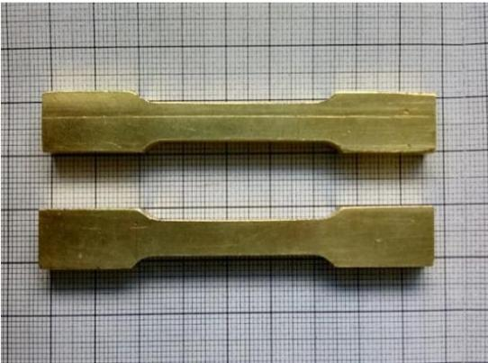
*Figura 3.12: Probetas de latón para ensayo de tensión.*
