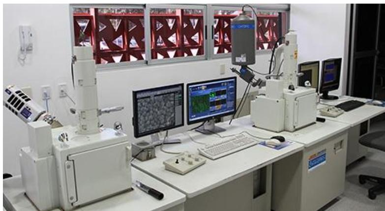
Figura 3.8: Microscopio electrónico de barrido, JEOL JSM-5900.
