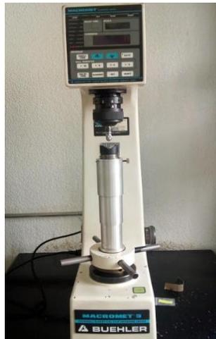
*Figura 3.9 Equipo para ensayo de dureza Rockwell (HR), Macromet 3 Buehler*
