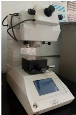
*Figura 3.10: Equipo Micro Hardness Tester, SHIMADZU.*
