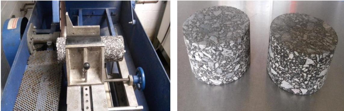
*Imagen 3.10 Cortadora para concreto asfáltico y geometría de especímenes
