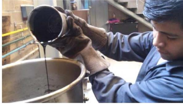
*Imagen 2.17 Colocación del cemento asfáltico
