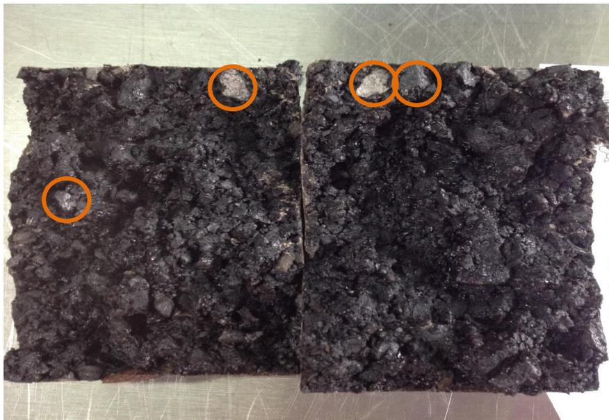
*Imagen 4.13 Espécimen 10, 7 %Va, Acondicionada, al concluir del ensaye
