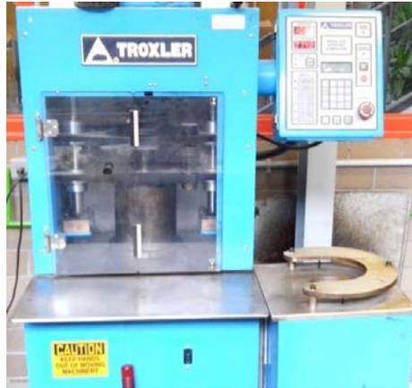
*Imagen 3.5 Compactador giratorio Troxler
