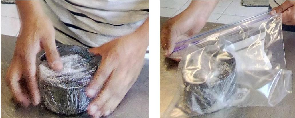
*Imagen 4.2 Recubrimiento de especímenes para acondicionamiento*
