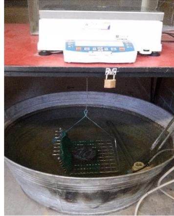
*Imagen 2.22 Espécimen pesado en condición saturada
