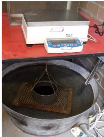
*Imagen 2.20 Mezcla asfáltica sumergida en agua
