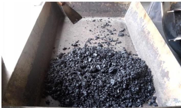
*Imagen 2.18 Mezcla asfáltica disgregada
