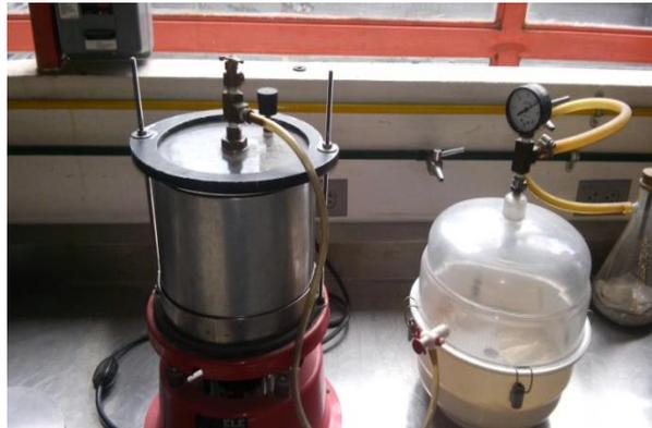
*Imagen 2.19 Presión a la mezcla asfáltica
