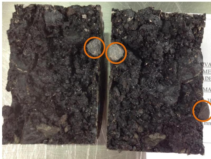
*Imagen 4.11 Espécimen 31, 4 %Va, Acondicionada, al concluir del ensaye
