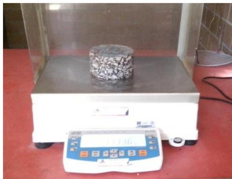
Imagen 2.21 Especimen pesada en condición seca
