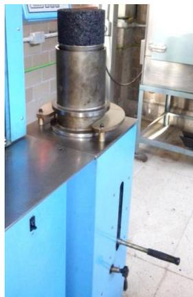
*Imagen 3.7 Especimen desmoldado*
