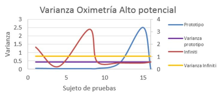
Graficas de etapa de alto potencial recuperatorio. \* Eje “y” izquierdo: prototipo [V]. \*Eje “y” derecho: Infiniti®; mioeléctrico [ $\mu$ V], electrodermica [S], oximetría [No se menciona en el manual]
