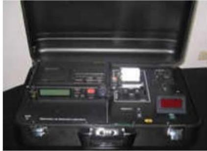
Figura 1 instrumento LANTERN 6000 usado para VSA análisis de estrés de voz [13]
